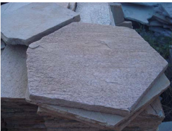
Figura 128 – Peças de revestimento elaboradas em quartzitos e produzidas na região.
