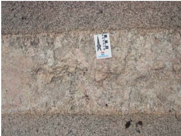
Figura 13 – Dique de pegmatito com bordas ricas em K-feldspato cortando o granito.
