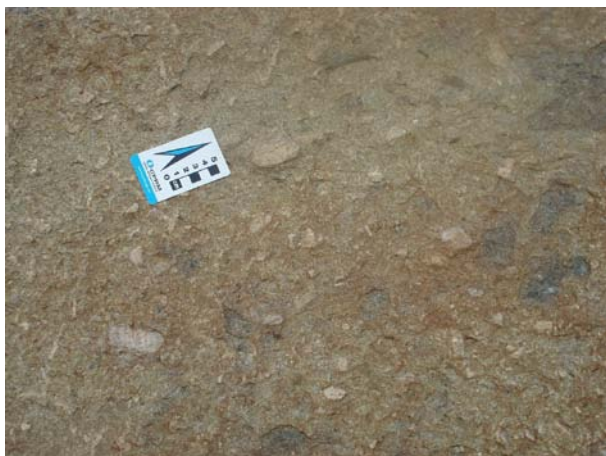
Figura 83 – Ortogneisse de composição granítica com fenocristais de K-feldspato, sob a forma de augens .
