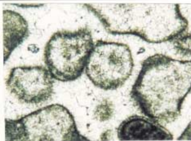
Foto 2 - Fotomicrografia de dolarenito composto por microfótilitos que exibem vestígios de franja isópaca acicular, originalmente aragônica. X.N. 80x
