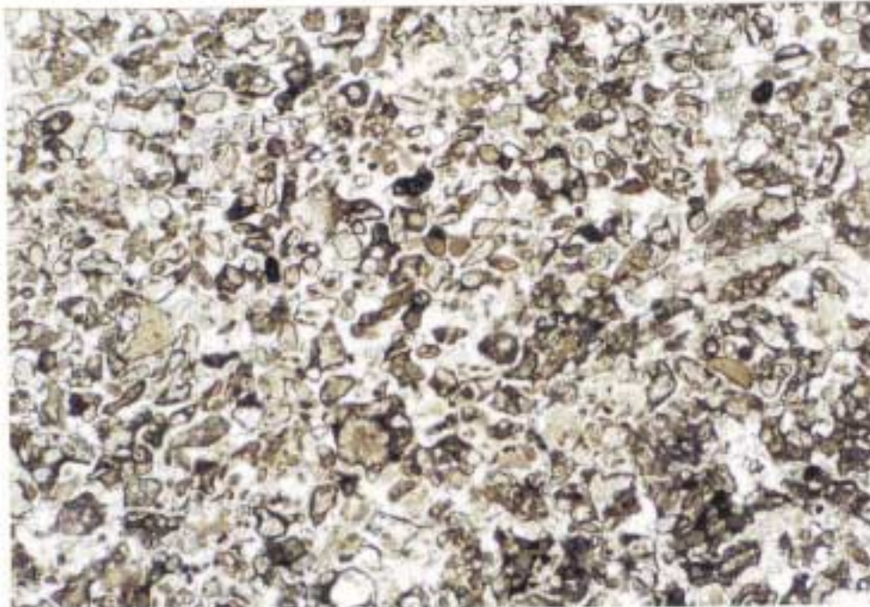
Foto 2 - Fotomicrografia do dolarenito com microfítólitos. Observar a grande variedade morfológica dos grãos. Topo da foto 1. L.N. 10x
