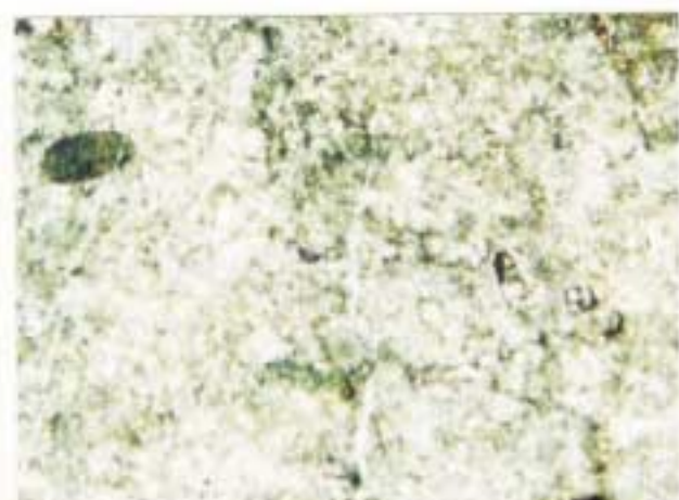
Foto 4 - Fotomicrografia de carbonato neomorfizado, onde se observa apenas vestígios de aloquímicos. X.N. 30x
