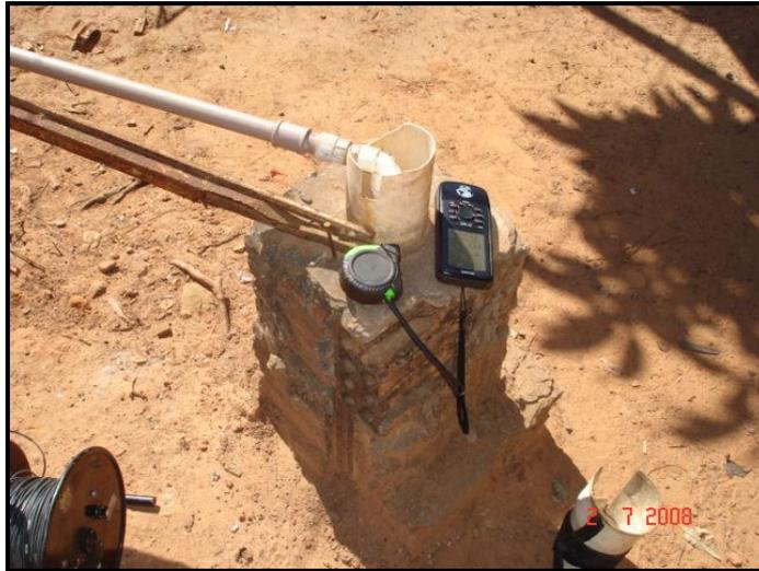
**Foto 4 – Medidor de nível utilizado para obtenção do nível estático em poço tubular no 2º Distrito.**
