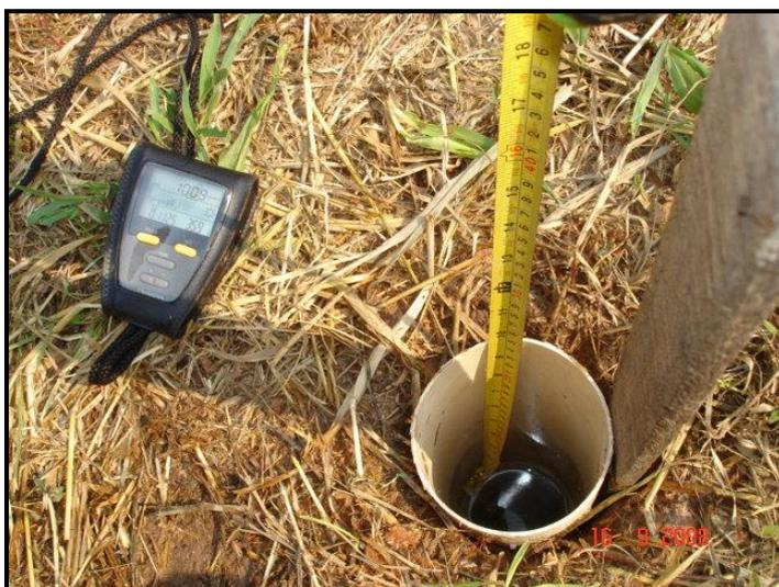
**Foto 3 – Execução de teste de infiltração nos sedimentos constituintes da zona vadosa do aquífero Rio Branco, de acordo com a metodologia proposta pela ABGE (1996).**
