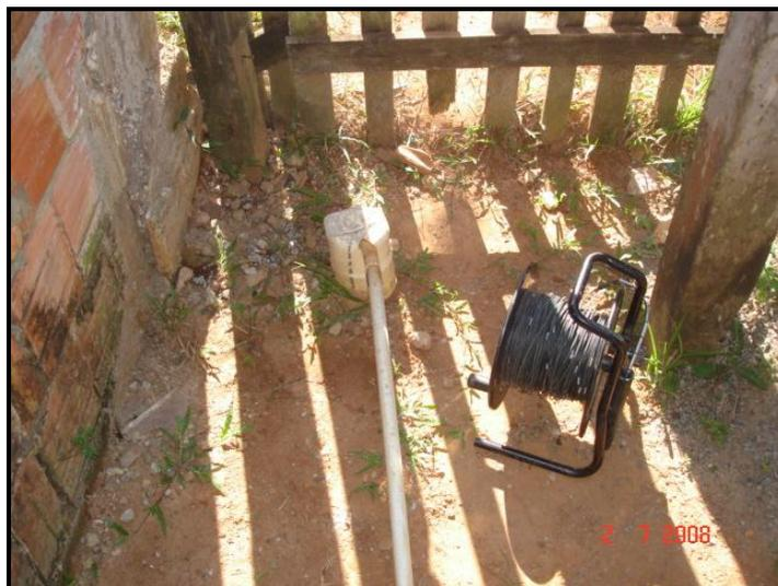
**Foto 5 – Medidor de nível e GPS utilizados para obtenção do nível estático e cadastro de poço tubular no 2º Distrito.**
