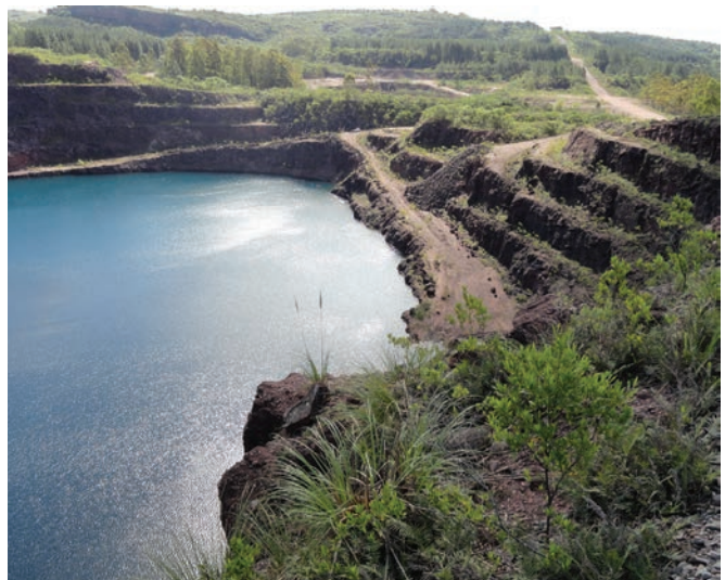
Fotos 8.36 y 8.37 – Detalle de los pisos de la cantera de la antigua mina Uruguai.
