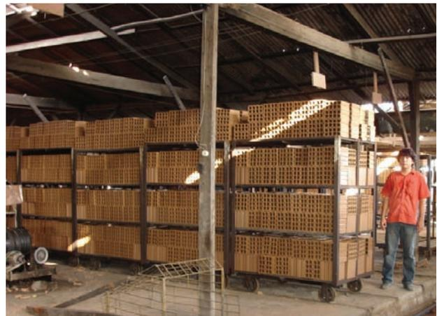
**Figura 13.7** - Potencial mineral: tijolos produzidos pela empresa Litiara, maior cerâmica da região do médio Amazonas, que utiliza a argila das planícies aluvionares como matéria-prima. Fonte: Projeto Materiais de Construção no Domínio Médio Amazonas (D'ANTONA et al., 2007).
