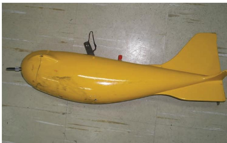
**Figura 4.15** - Amostrador de sedimentos em suspensão.
