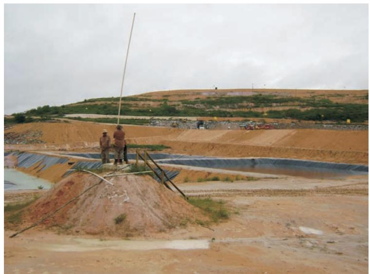
**Figura 5.9** - Acima, terreno onde estão situados vários poços rasos do sistema de abastecimento público de água de Parintins, ladeado por canais naturais, não impermeabilizados, de esgotos domésticos; abaixo, amostragem em poço de monitoramento na borda norte do aterro sanitário de Manaus (ASM).
