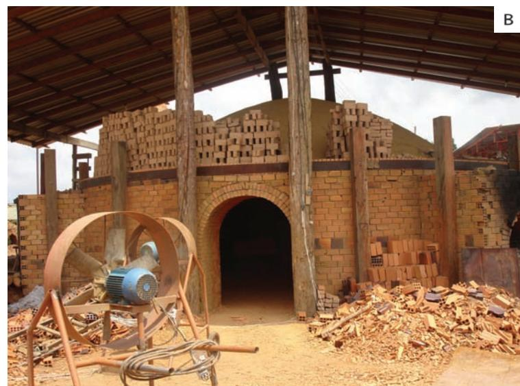
**Figura 10.1** - (A) Lavra de argila dos depósitos de terraços aluvionares da região do rio Manacapuru (fabrico de tijolos). (B) Forno tipo "abóbada" para fabricação de tijolos de oito furos (Manacapuru, AM). Fonte: Teixeira et al. (2009).
