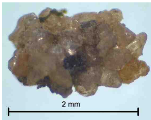
Figura 4.44 - Agregados de minerais com cimentação carbonática. (Área X; Prof. 14,82 m)
