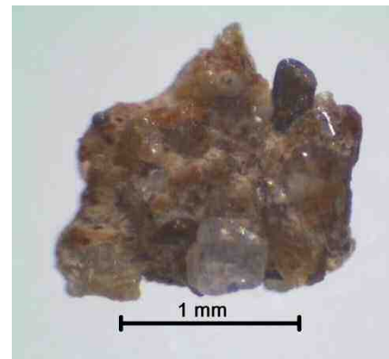
Figura 4.45 - Agregados de minerais com cimentação carbonática. (Área X; Prof. 9,48 m)
