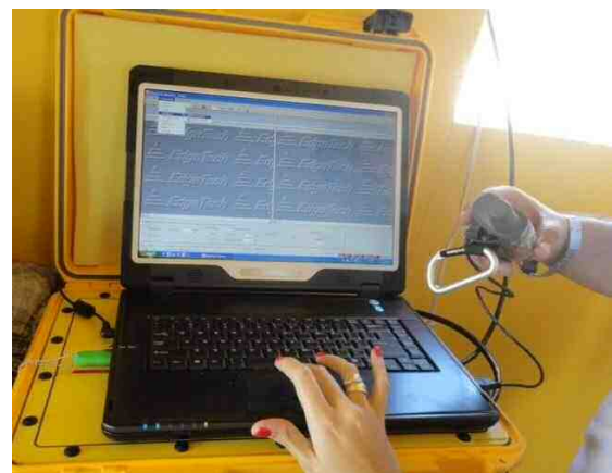
Figura 3.14 - Programação do Computador de bordo e do GPS acoplado para aquisição dos dados.
