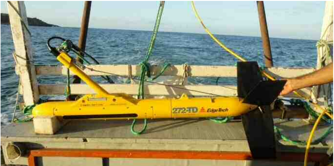
Figura 3.15 - Towfish “peixe ou torpedo”, Modelo 272-TD, da marca EdgeTech, usado para aquisição dos dados Sonográficos.
