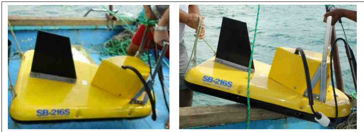
Figura 3.4 - Equipamento Sub-bottom profiler utilizado para aquisição dos dados sísmicos.
