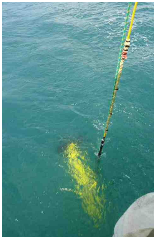
Figura 3.16 - “Torpedo” Towfish sendo baixado na água, conectado por cabo ao computador de bordo na embarcação.
