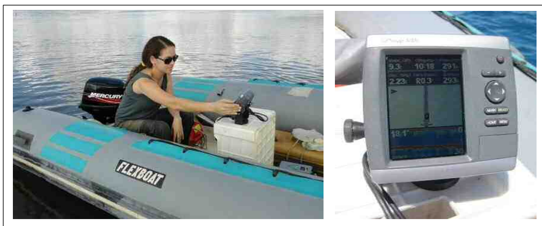
Figura 3.8 - Trabalho de aquisição dos dados. À direita, detalhe do ecobatímetro utilizado.
