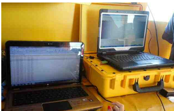
Figura 3.13 - À direita, computador utilizado para aquisição dos dados Sonográficos . À esquerda, notebook com os perfis planejados.
