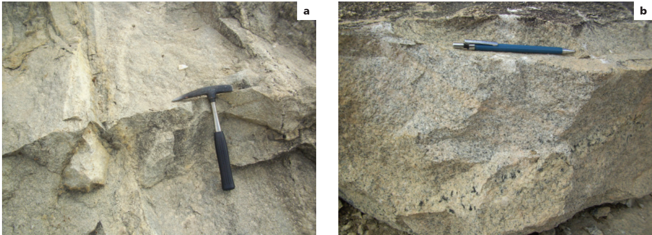
Figura 4.79 - Granitoides não-deformados da unidade geológico-ambiental 46. (a) detalhe de maciço de comportamento geomecânico isotópico – pouco fraturado (município de Itinga); (b) detalhe de bandamento composicional incipiente (município de Jequitinhonha).
