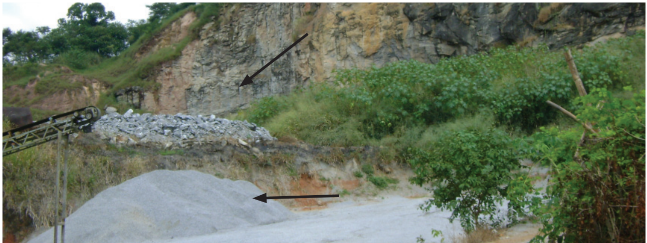
Figura 4.97 - Pedreira de litotipos da unidade geológico-ambiental 62; as setas destacam material usado na construção civil: brita e pedrisco (município de Urucânia).
