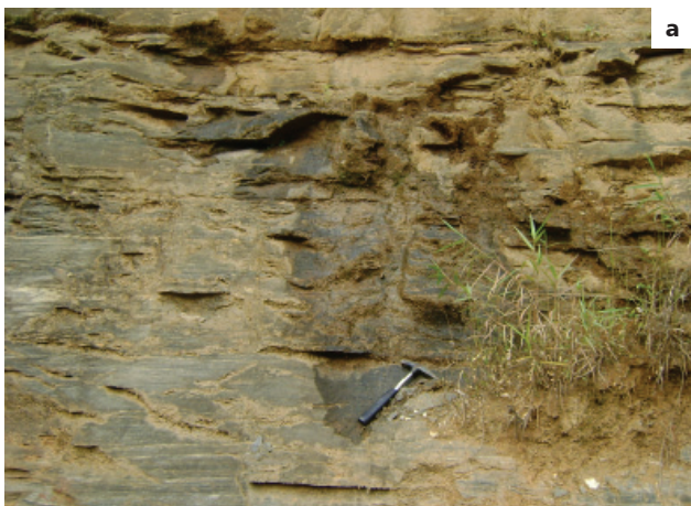
Figura 4.94 - Surgência de água ao longo de discontinuidades geomecânicas em maciços da unidade geológico-ambiental 62 no município de Ponte Nova. (a) talude de corte com surgência de água ao longo de bandamento migmatítico; (b) área úmida com surgência de água ao longo do plano de fratura – formação de zona de alteração intempérica (área pontilhada).
