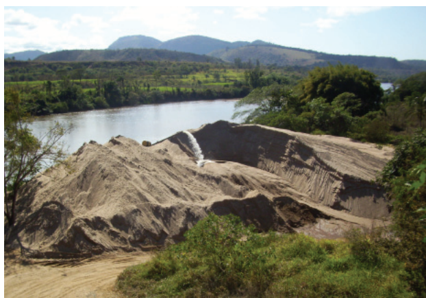
Figura 4.5 - Extração de areia para uso na construção civil (rio Santo Antônio, município de Belo Oriente).
