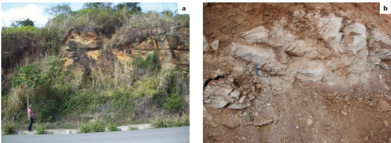
Figura 4.80 - Litologias das unidades geológico-ambientais 47 e 48 com potenciais à queda de blocos. (a) maciço medianamente alterado e muito fraturado de litotipos da unidade geológico-ambiental 48 (município de Carlos Chagas); (b) manto de alteração de litotipos da unidade geológico-ambiental 47, com alto grau de fraturamento (município de Monte Azul).
