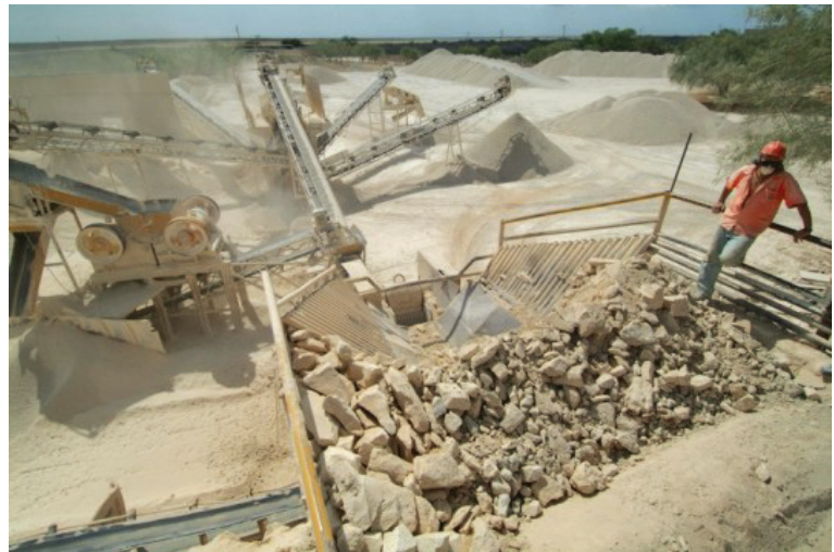
Figura 4.9 - Unidade de britagem e classificação de brita da mina Serrinha (São Gonçalo do Amarante).
