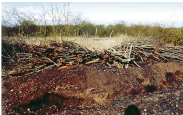
Figura 10.9 - Trincheira de forno para produzir carvão (lenha empilhada ao fundo).
