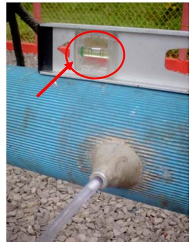
**Figura 4** - Fotografia atestando a horizontalidade do tubo de descarga (escoador) através do nível de bolha posicionado acima da tomada piezométrica
