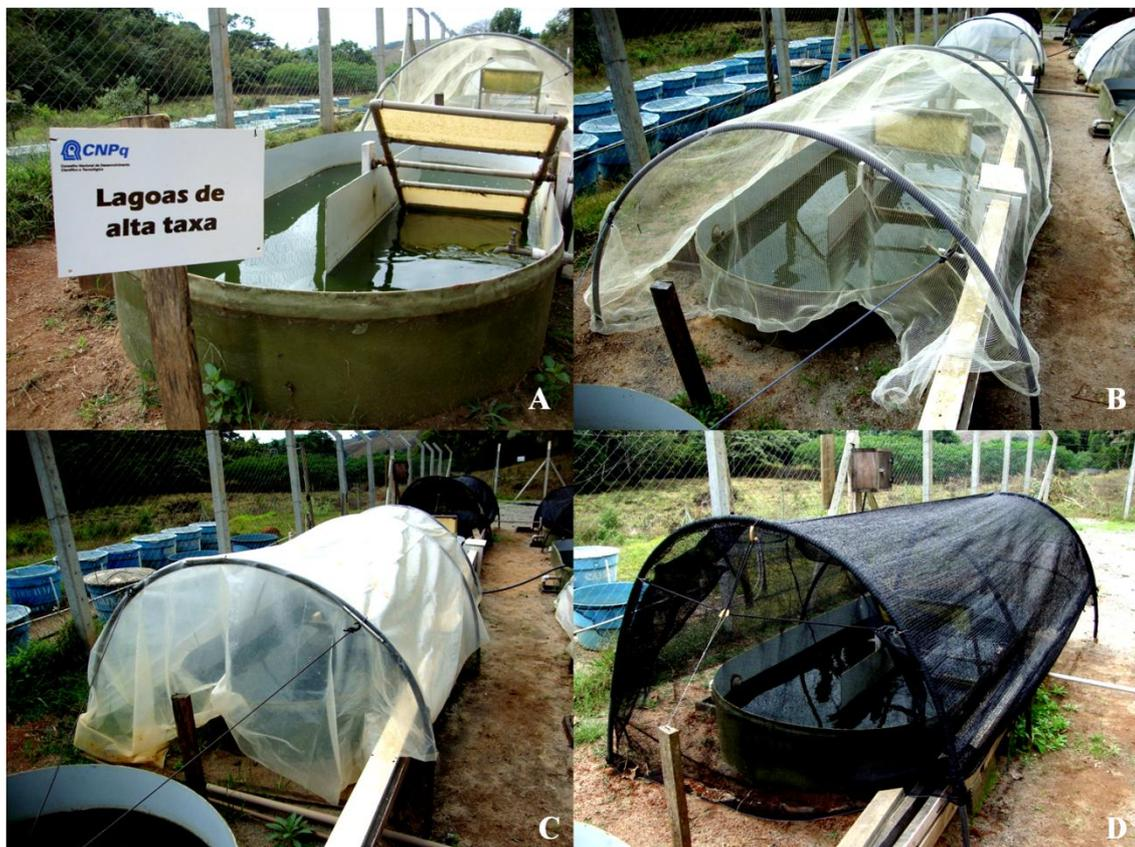
Figura 4. Lagoas de alta taxa experimentais. A: LAT1 -Testemunha (sem cobertura); B: LAT2 - Sombrite 30%; C: LAT3 - Plástico Transparente; D: LAT4 - Sombrite 70%.
