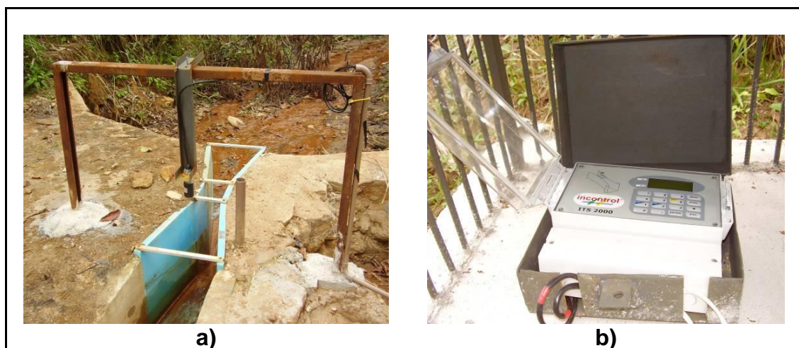
Figura 8 – a) Calha Parshall e sensor do ITS instalados na saída da BHCZ; b) ITS-2000 instalado junto a calha na Bacia Hidrográfica do Córrego Zerede, em Timóteo-MG, 2006.
