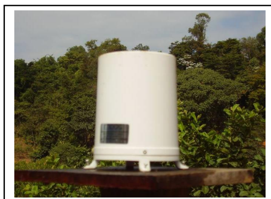
Figura 7 - Pluviômetro digital sem fio instalado na Bacia Hidrográfica do Córrego Zerede, em Timóteo-MG, 2006.
