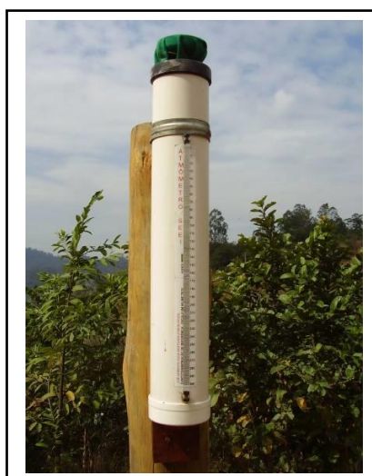
Figura 9 - Atmômetro modificado instalado na Bacia Hidrográfica do Córrego Zerede, em Timóteo-MG, 2006.
