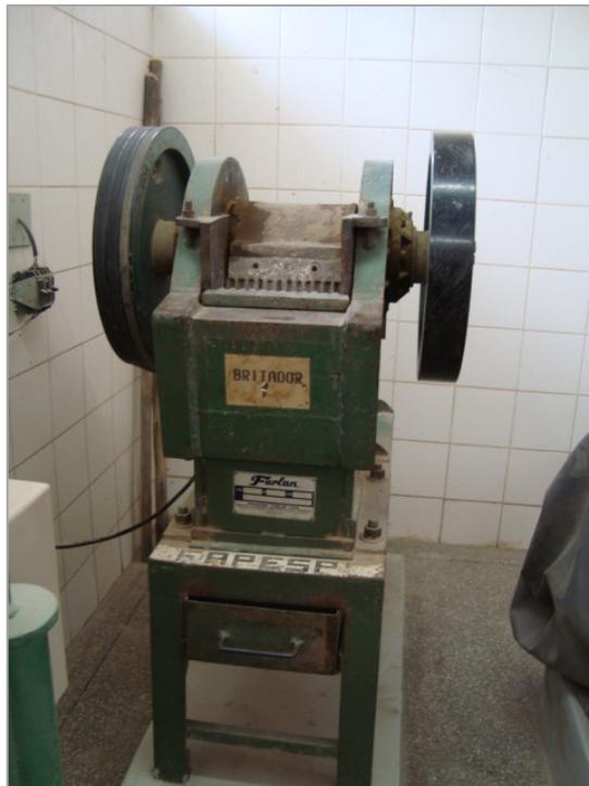
**Foto 1 – Britador de Mandíbula (tipo Furlan BM 2010/nº 95047/RPM 360) do Laboratório da Universidade Estadual Paulista (DPM-IGCE/UNESP). Tritura amostras à dimensão de 1x1 cm.**
