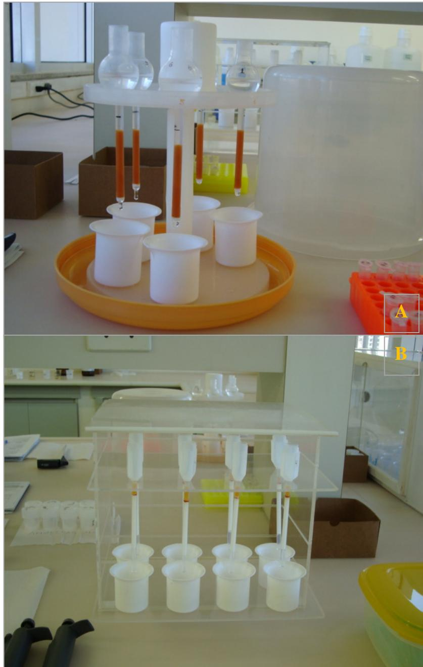
Foto 7 – (A) Separação dos ETRs (Coluna Primária); (B) Separação do *Sm/Nd* (Coluna Secundária), do Laboratório de Geocronologia e Geologia de Isótopos da Universidade de Brasília (UnB).
