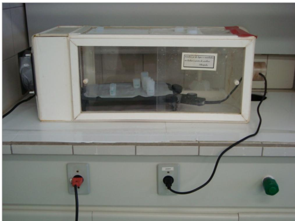
Foto 6 – Clean Box do Laboratório de Geocronologia e Geologia de Isótopos da Universidade de Brasília (UnB).
