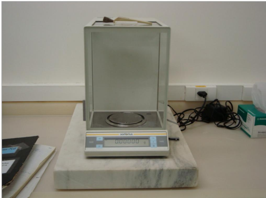
**Foto 4 – Balança Analítica (Sartorius), do Laboratório de Geocronologia e Geologia de Isótopos da Universidade de Brasília (UnB).**
