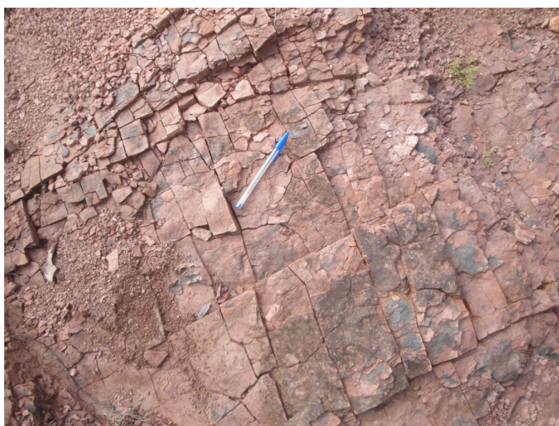
Figura 4.27 - Arenito arcoseano verticalmente fraturado da Formação Diamantino. Além de intensamente fraturado contém porosidade matricial, evidenciado pelo seu caráter friável mesmo em amostras de rocha fresca (UTM 470881 / 8268302).
