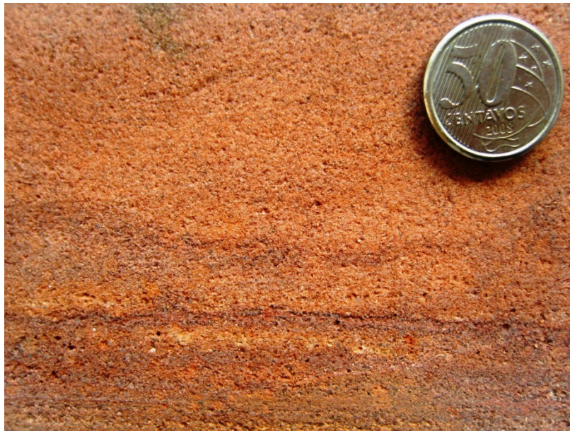
Figura 4.13 - Amostra de mão mostrando textura submatura e considerável porosidade intergranular primária residual nos arenitos da Formação Raizama (UTM 578859 / 8382840).
