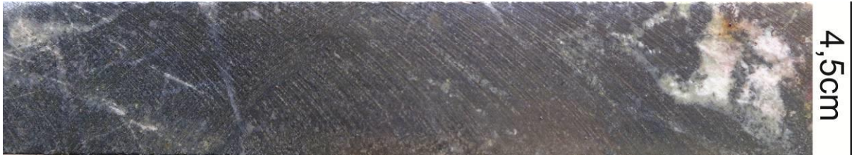
Figura 62 - Rocha derivada de protólito máfico com estrutura maciça e textura granular fanerítica fina a média, classificada em campo como gabro. A rocha é cortada por zonas albitizadas (canto direito da fotografia) e vênulas de quartzo (faixas cinza claro).
