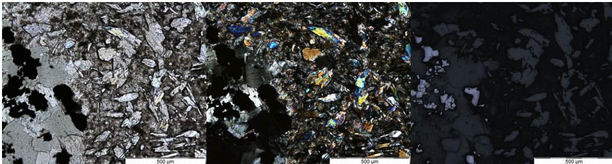
Figura 39 – Fotomicrografias do contato entre a região esverdeada com a esbranquiçada da rocha ultramáfica. Clorita associada à magnetita (lado esquerdo das fotomicrografias) em contato com zona com talco (minerais incolores com alta cor de interferência) e cristais maiores de anfibólios, representados nesse caso por tremolita. Fotomicrografia da esquerda com luz polarizada simples transmitida, do centro com luz polarizada cruzada transmitida e da direita com luz refletida.
