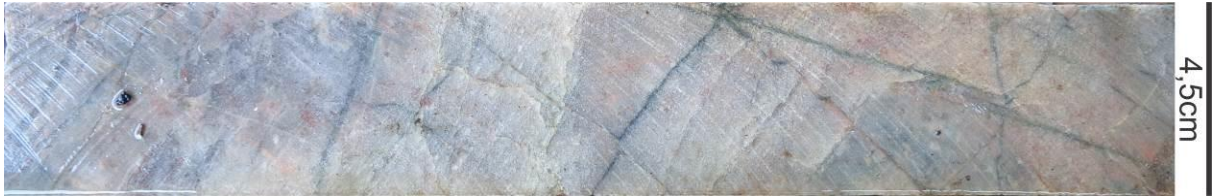
Figura 46 – Rocha ácida com textura fanerítica fina, albitizada pervasivamente (regiões com coloração rosa clara) e com fraturas tardias preenchidas por sericita ou clorita (mineral verde).
