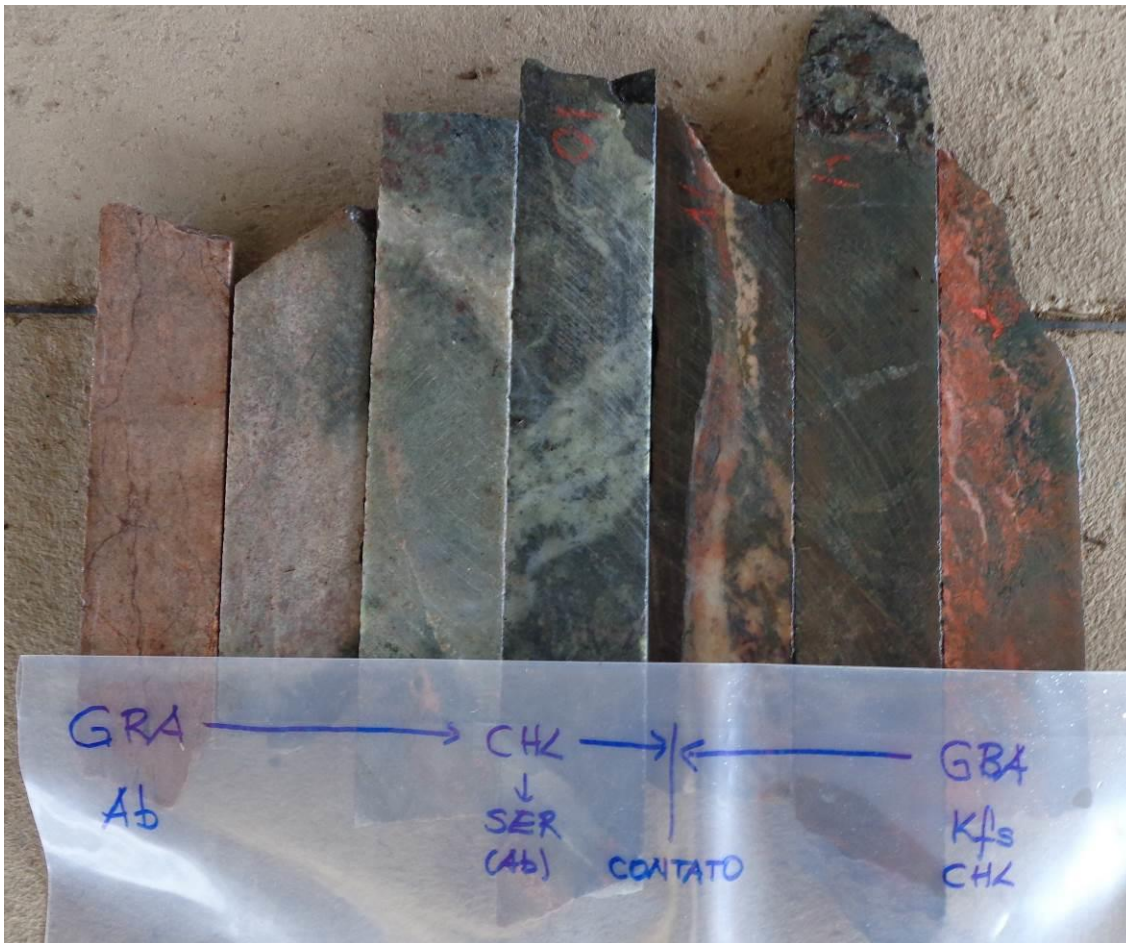
Figura 154 – Esquema montado em campo mostrando relação entre zonas de alteração hidrotermal e litologia hospedeira, com predominância de alteração sódica com albita nas rochas félsicas, sobreposta por cloritização próximo ao contato com o gabro. Notar que o gabro próximo a esse contato também apresenta alteração potássica com feldspato potássico, sobreposta por cloritização. GRA – Rocha granítica; GBA – “Gabro” (rocha máfica); Ab – Albitização, Chl – Cloritização; Ser – Sericitização, Kfs – Alteração potássica por feldspato potássico. O diâmetro dos testemunhos de sondagem é de 4,5 cm.
