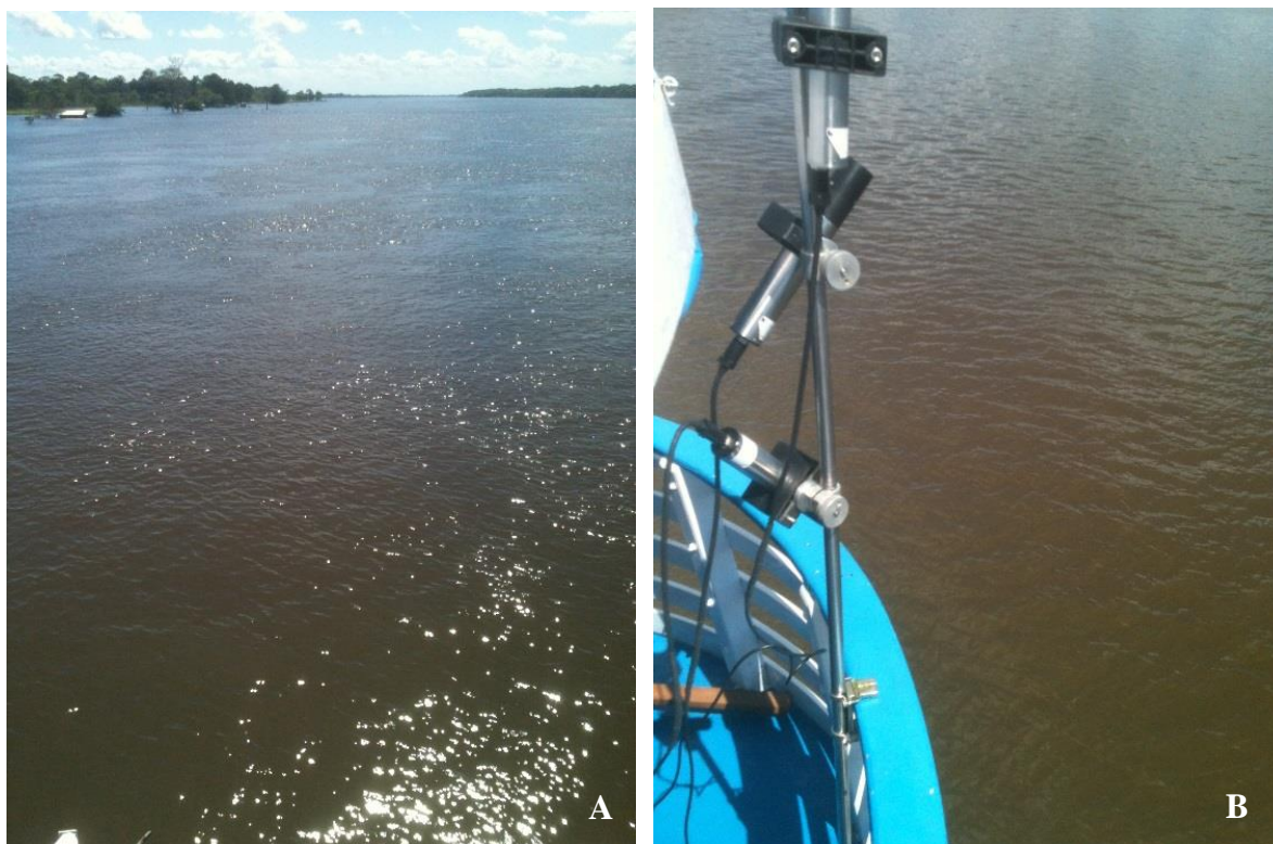
Figura 27. Em (A) espalhamento de luz na superfície da água e em (B) posição com o correto ângulo azimutal. Santos, 2015.
