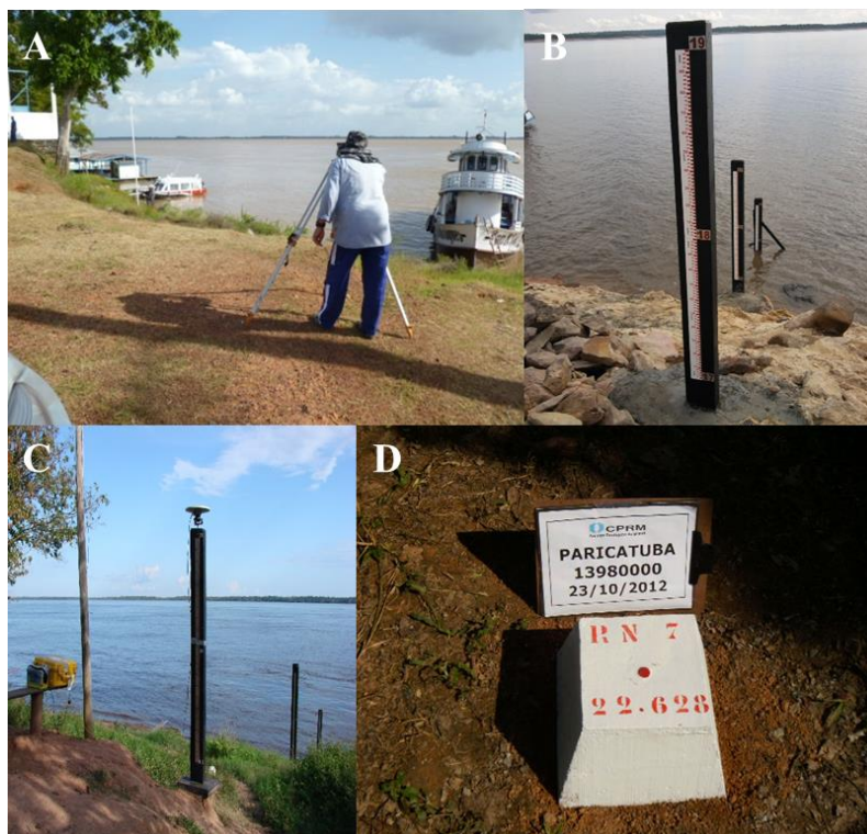
Figura 21. Nivelamento topográfico (A) e por GPS (C) nas estações Fluviométricas (B) Exemplo de referência de nível (D). Fonte: Santos, 2015.
