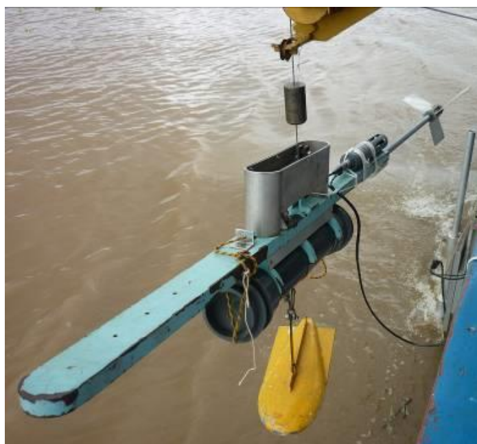
Figura 22. Amostrador pontual instantâneo tipo Callède com lastro de 50Kg. Santos, 2013.
