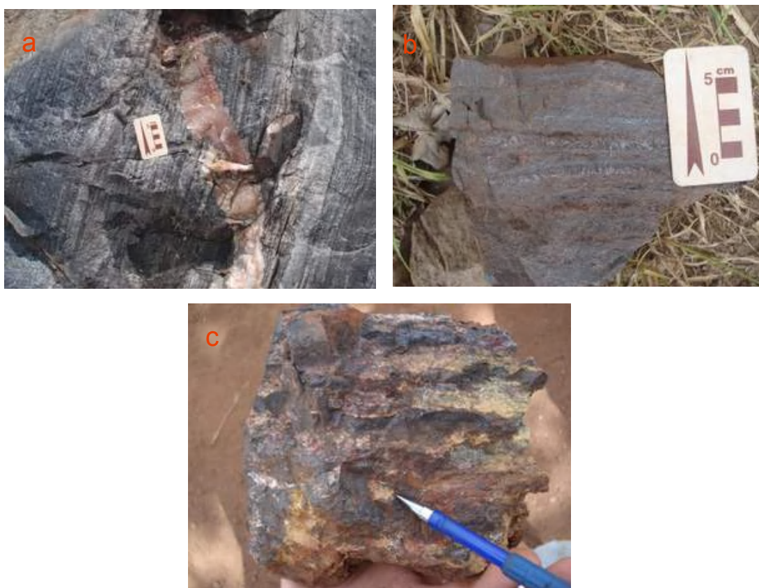
Figura 11: Formação ferrífera bandada exibindo feições características, hematita quartzito com veios de quartzito discordantes (a); formação ferrífera bandada com níveis de magnetita(b) e hematita xisto manganesífero (c).
