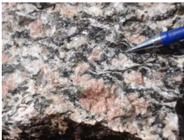
Figura 13: Granito foliado com porções máficas estiradas.
