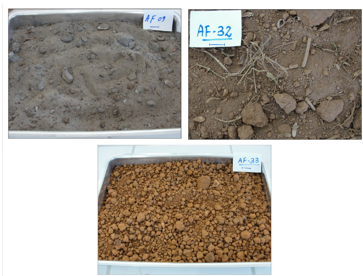
Figura 51: Amostras de solo: (AF-09) solo saprolítico; (AF-32) solo magnético rico em matéria orgânica e (AF-33) solo laterítico.
