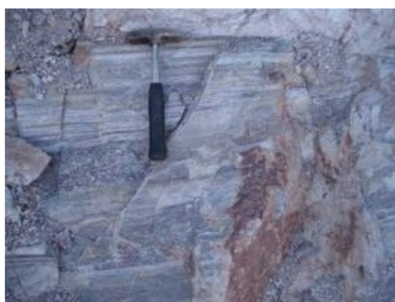
Figura 15: Rocha alterada, com níveis quartzosos intercalados com níveis micáceos (quartzito micáceo), ocorrem diques de granito cortando o pacote.
