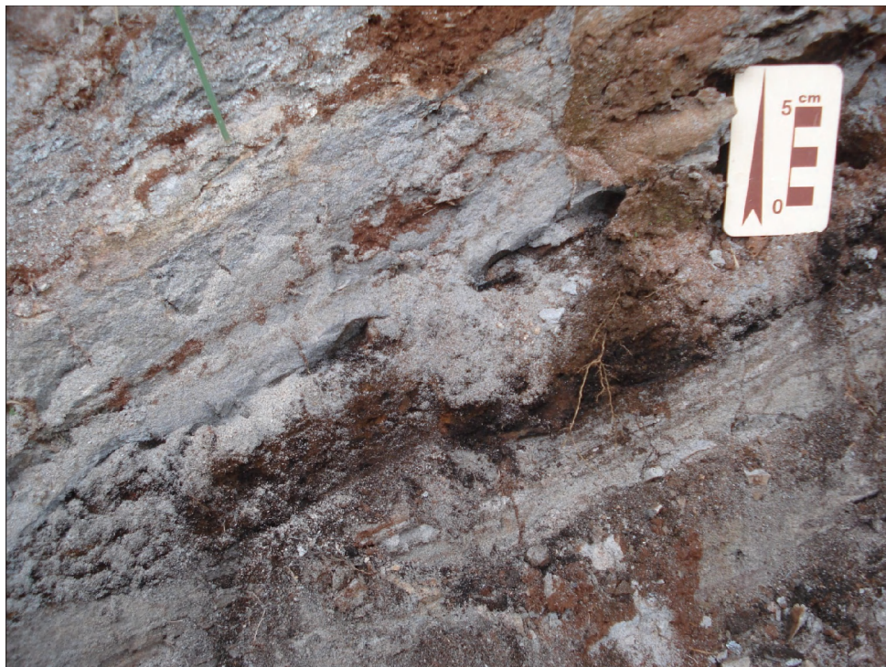
Figura 38: Elementos estruturais em saprólito; acamamento sedimentar e foliação subparalela (N60E/40NW), com fragmentos de quartzo estirados.
