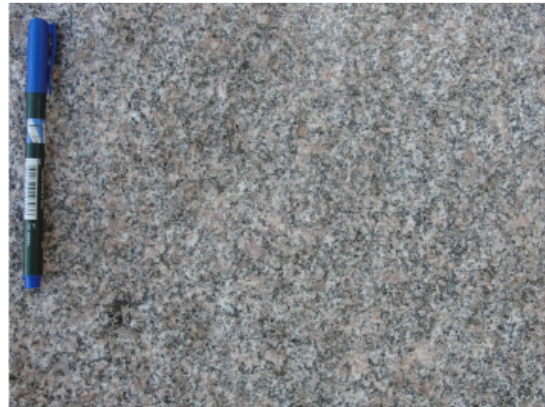
Figura 32 – Cinza Vandin - Detalhe da textura.
