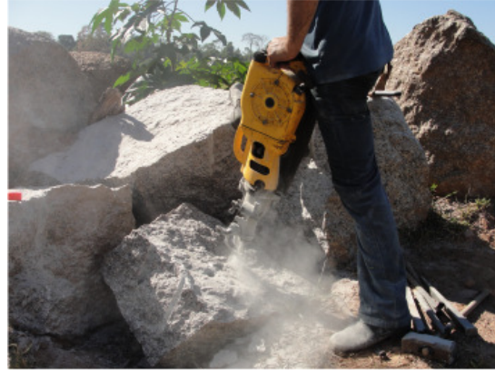
Figura 34 – Granitóide porfiróide – Detalhe da retirada dos blocos
