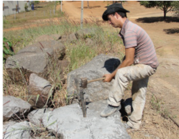
Figura 03 – Retirada de amostras com o auxílio de cunhas.
