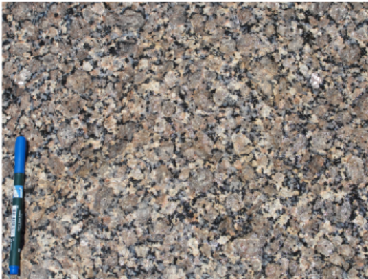
Figura 35 – Granitóide porfiróide – Aspecto geral da textura in situ.
