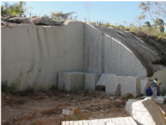
Figura 51 – Sienogranito – Detalhe da frente de lavra.
