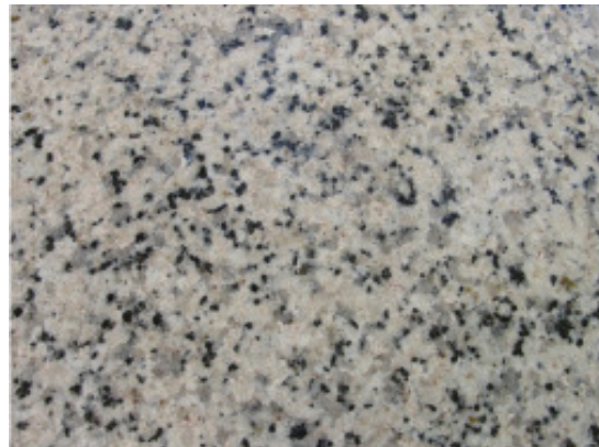
Figura 52 – Sienogranito – Detalhe da textura in situ.
