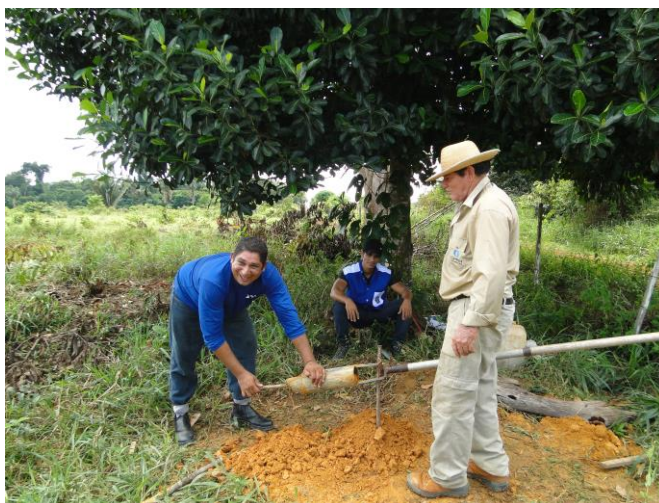
Figura 29. Ensaio geotécnico com trado.
