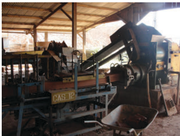
Figura 4.11 – Estrutura da cerâmica com “maromba” alimentada pelo laminador.
