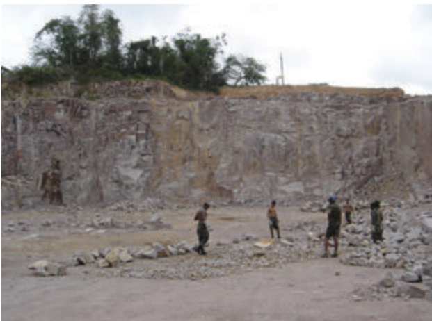
Figura 4.34 – Aspecto da cava da pedra do DEMA, mostrando bancada de exploração, na região da cachoeira de Santo Antônio.
