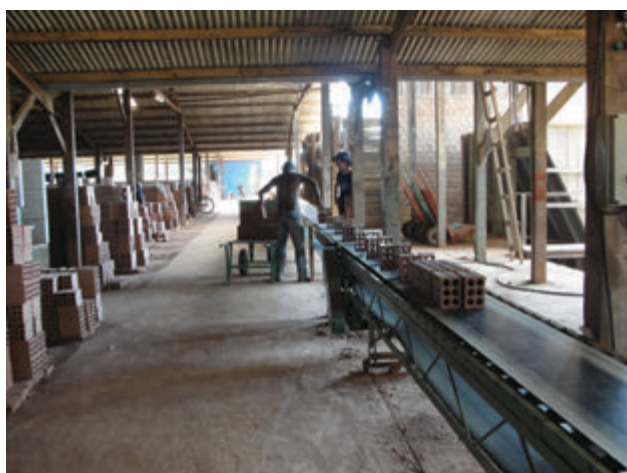
Figura 4.12 – Operário retirando tijolo “cru” para a etapa de secagem.
