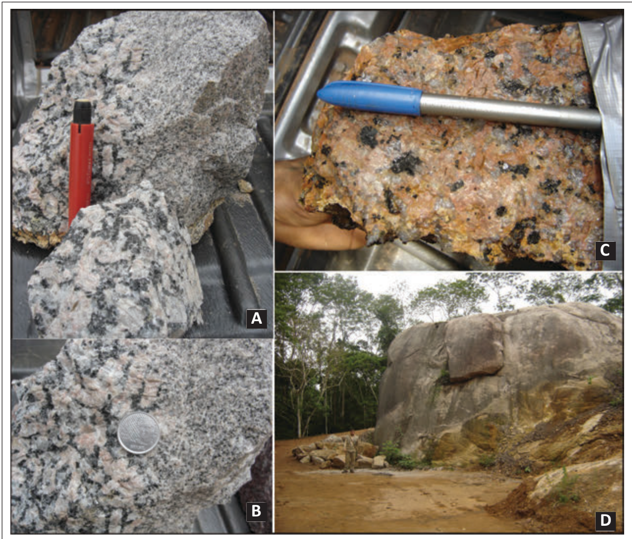
Figura 3.5 – Granito da Suíte Intrusiva Santo Antônio - (A) Contato de distintas fácies graníticas; (B) Detalhe do contato (C) Fácies inequigranulares de cor rósea, nas proximidades do balneário cachoeirinha; (D) Área de exploração da pedra GM engenharia (brita).
