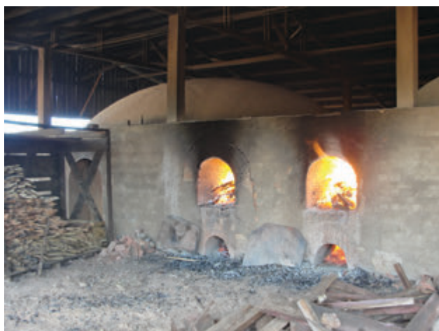
Figura 4.13 – Processo de queima observa-se o sarrafo (resto de madeira) como combustível.
