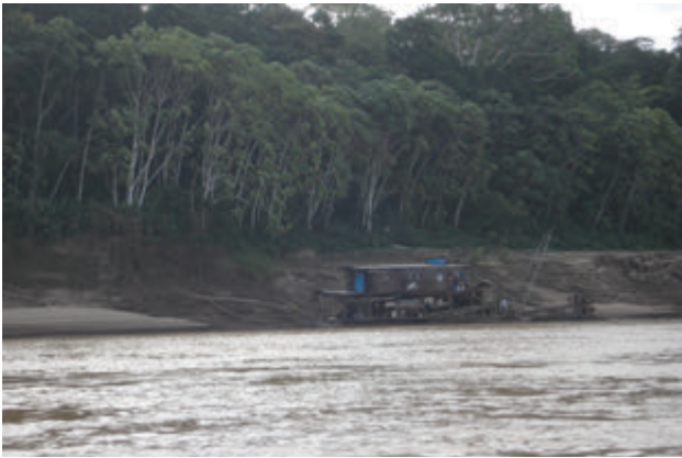
Figura 4.3 – Vista geral de uma draga no rio Candeias jogando material arenoso e água para o pátio de estocagem para procedimento de secagem.
