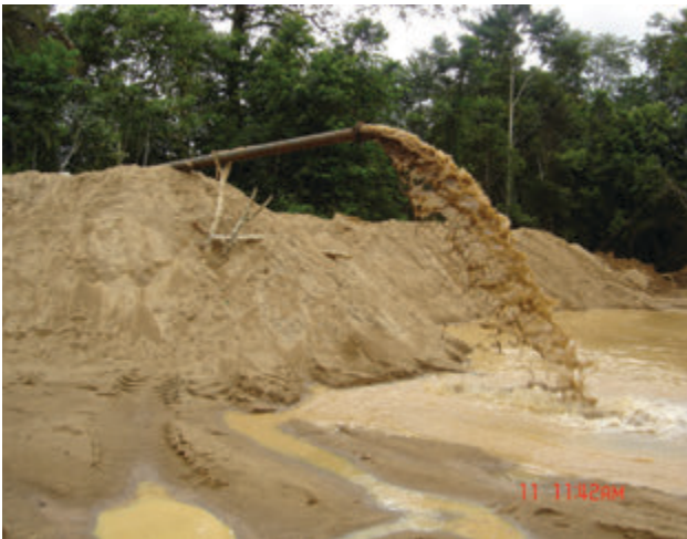
Figura 4.4 – Tubulação da draga no rio Candeias, retirando material arenoso e água para o pátio de estocagem para procedimento de secagem.
