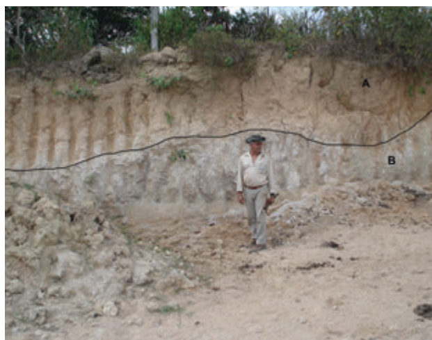
Figura 4.28 – (A) Cobertura areno-argilosa sobre camada de argila branca (B) de sedimento aluvionar.
