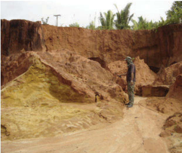
Figura 5.4 – Erosão formando sulcos em lavra de caráter intermitente.
