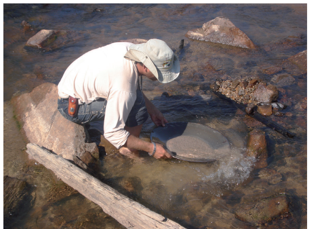
Foto 5.4 - Procedimento de coleta de concentrado de bateia. Etapa de bateamento da amostra.
