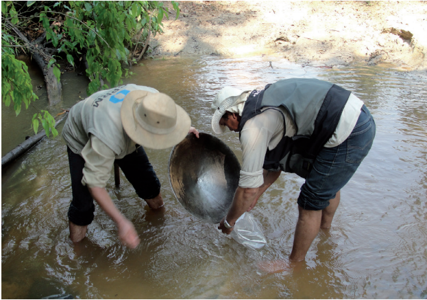
Foto 5.5 - Procedimento de coleta de concentrado de bateia. Etapa de armazenamento da amostra.
