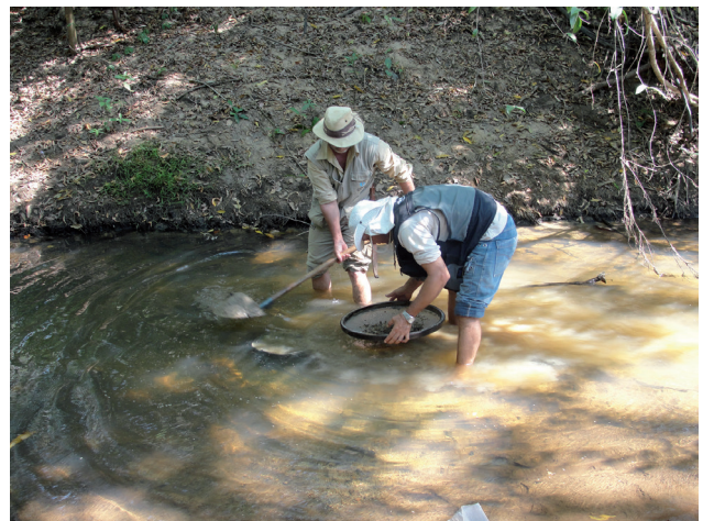
Foto 5.3 - Procedimento de coleta de concentrado de bateia. Etapa de peneiramento de amostra.
