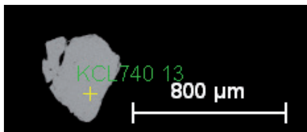
Foto 6.1. Imagem BSD de cristal de cassiterita homogênea e destituída de inclusões sólidas.
