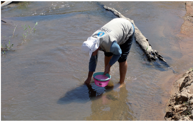
Foto 5.1 - Procedimento de coleta de sedimento de corrente em leito ativo.
