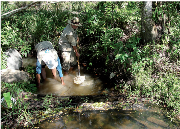
Foto 5.6 - Procedimento de coleta de concentrado de bateia. Coleta de amostra em concentradores naturais (antigos troncos de árvores).
