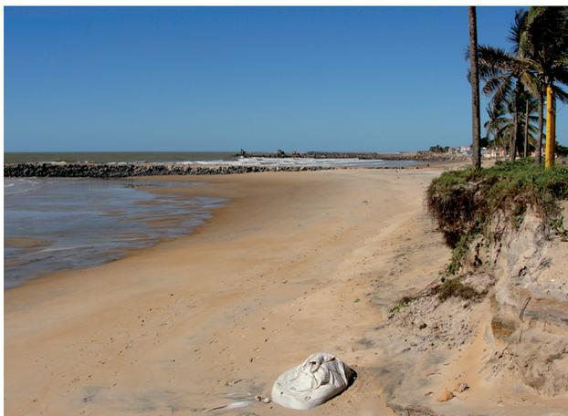
**Figura 4.9** - Exposição da raiz de um coqueiro, causada pela erosão marinha (à direita da foto). Ao fundo, a instalação de duas linhas de enrocamentos para conter este processo (município de Conceição da Barra). Foto: Marceley Machado, 2010.
