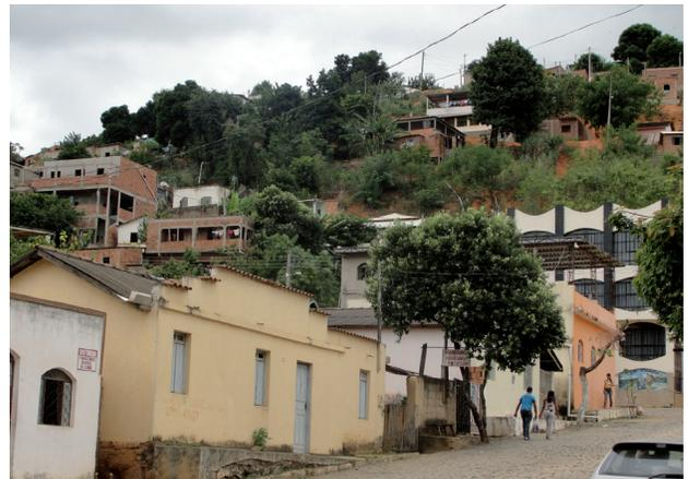
**Figura 1.6 -** Ocupação inadequada de encosta condicionando situação de risco por deslizamento, Barra do São Francisco, ES. Foto: Marceley Machado, 2010.
