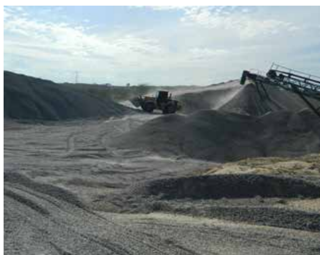
Foto 8.7 – Carregamento para expedição pela forma mecanizada (1, com pá carregadeira) ou automatizada (2, diretamente das correias), município de Macaíba, localidade de Jundiá.
