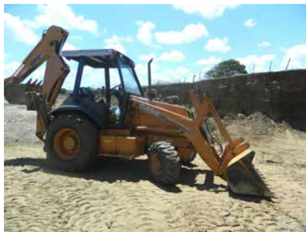
Foto 8.19 – Retroescavadeira CASE, equipamento comumente utilizado na RMN no desmonte da argila, frete de lavra da Cerâmica Sales Nogueira no município de São Gonçalo do Amarante.
