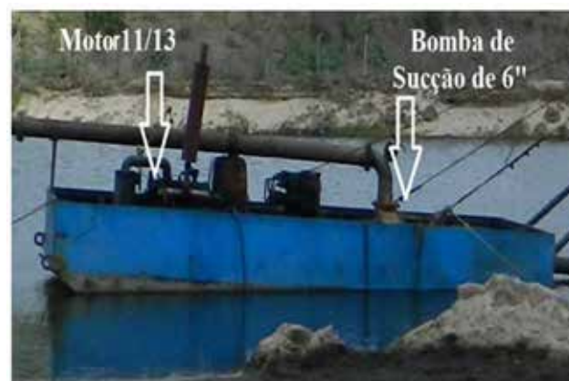
Foto 8.13 – Draga com bomba de sucção de 6" (seis polegadas) acoplada a motor diesel de 6 cilindros 11/13 comumente utilizada na exploração de areia na RMN, localidade de Quatro Bocas, município de Ilmo Marinho.
