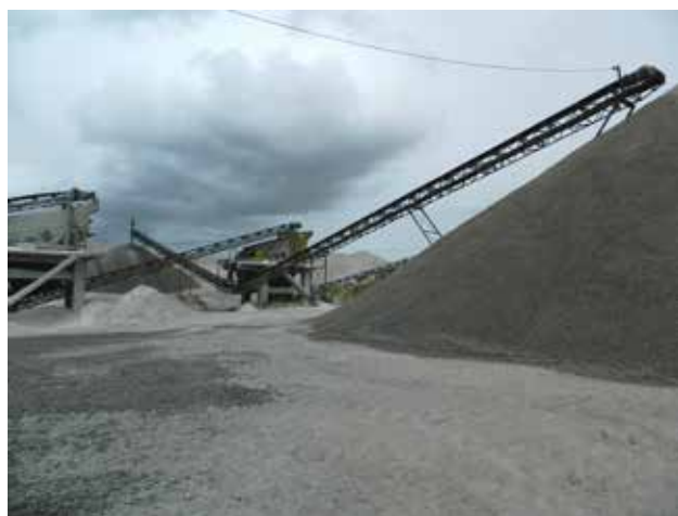
Foto 8.6 – Etapa de classificação do material britado (peneiras com decks), município de São Gonçalo do Amarante, localidade Serrinha de Cima.
