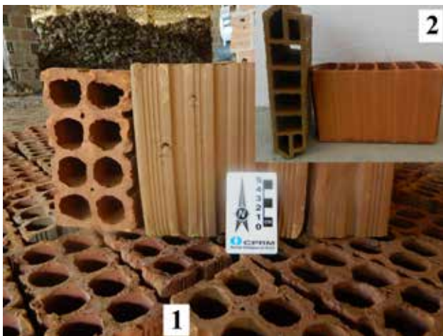
Foto 8.22 – Principais produtos comercializados pelas olarias da RMN, (1) tijolos de 8 furos (9 x 19 x 19 cm) e (2) lajotas (30 x 8 x 19 cm).
