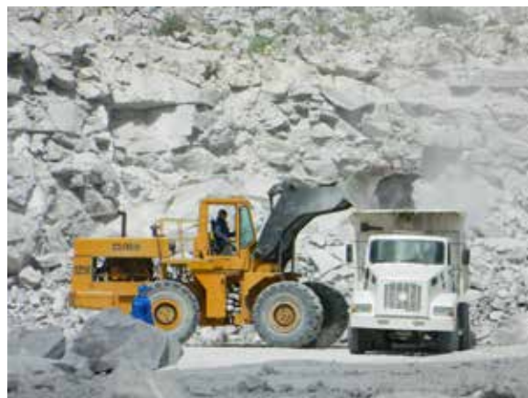
Foto 8.2 – Carregamento realizado por carregadeira sobre pneus, município de São Gonçalo do Amarante, localidade de Serrinha de Cima.
