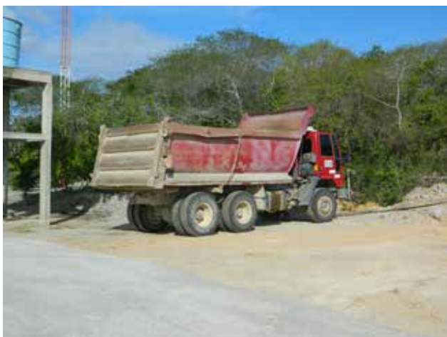
Foto 8.8 – Caminhão basculante rodoviário, equipamento mais utilizado no transporte de brita na RMN. município de Macaíba, localidade Jundiá.
