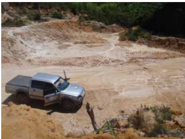
Foto 6.6 – Extração de argila sem nenhuma recuperação, provocando transporte de material para as partes baixas provocando assoreamento, na zona rural de Cabo de Santo Agostinho. (Foto do Projeto insumos Minerais para a Construção Civil na Região Metropolitana do Recife), Assunção, et. al., 2012.
