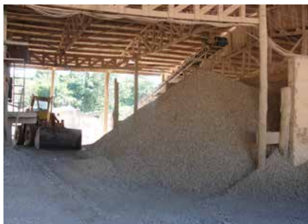
Figura 8.6 – Pilha pulmão onde o material é estocado antes de ser transportado por correias até os moinhos de matelos.
