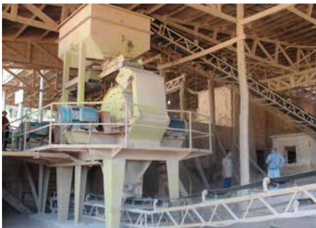
Figura 8.7 – Moinhos de martelos IMETEC 120 B 9, etapa de moagem antes da estocagem do produto final, na usina antiga da Companhia de Mineração de Rondônia – CMR.
