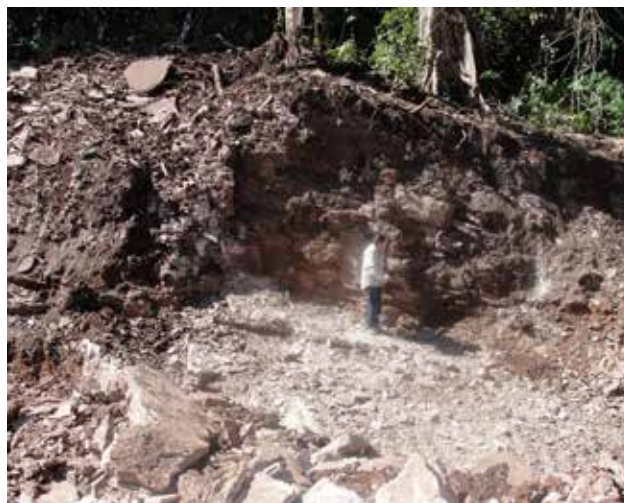
Figura 6.1 – Desmatamento e remoção do solo no desenvolvimento da lavra de calcário, em Pimenta Bueno.
