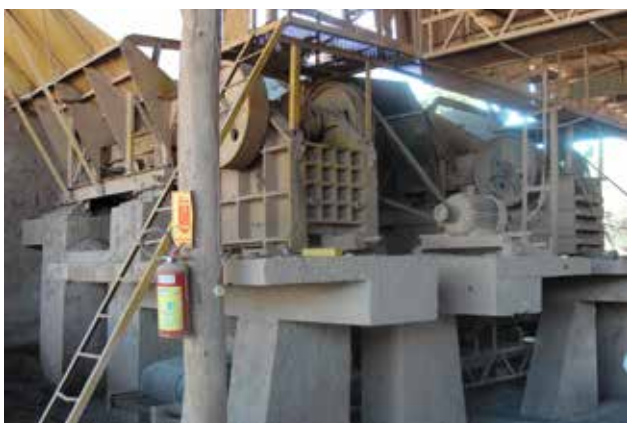
Figura 8.3 – Britadores de mandíbulas BRITERPA 40X65 e FORLAN 40X60, utilizados na etapa inicial de fragmentação do calcário agrícola na usina antiga da Companhia de Mineração de Rondônia – CMR.
