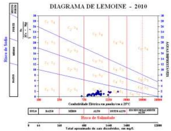
Figura 9- Diagrama de Lemoine mostrando o comportamento das águas subterrâneas para a finalidade agrícola coletadas no aquífero Salitre em 2010
