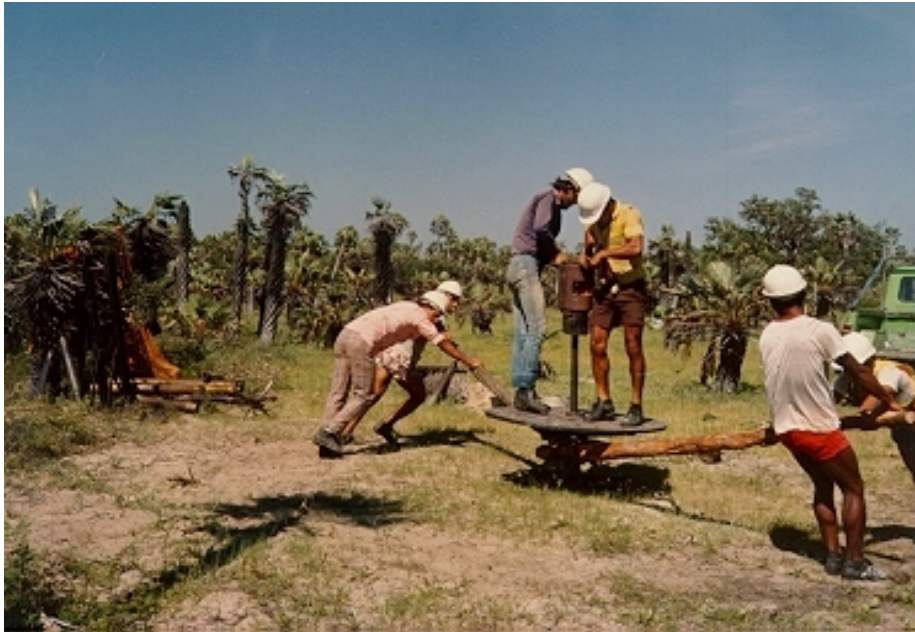
Foto 11 - Operação com trado para determinação da espessura do capeamento arenoso sobre os níveis de cascalho.
