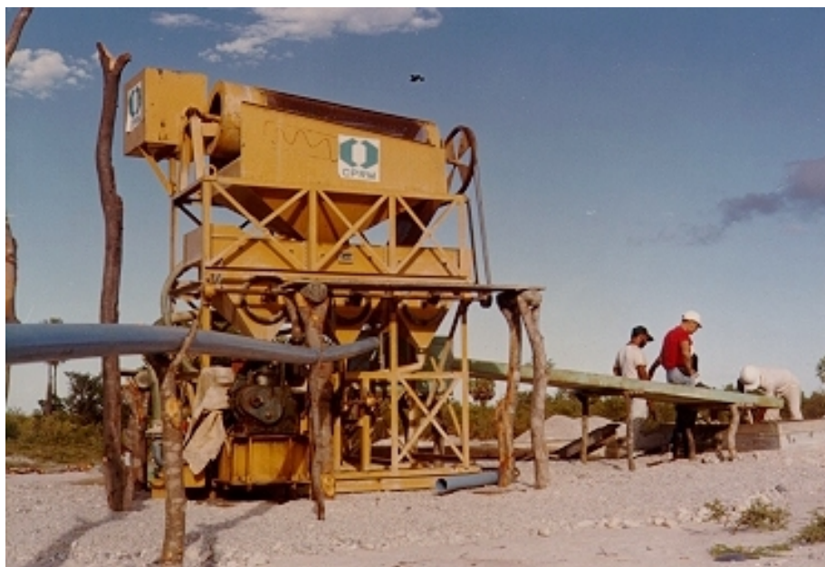
Foto 9 - Vista do equipamento OURETEC M-10 em operação. Na parte superior caixa de entrada e “Tromel”; na parte mediana, sistema de três “Jigs” paralelos e na parte inferior outro “Tromel” (concentrador final). Na saída, bica inclinada concentradora.
