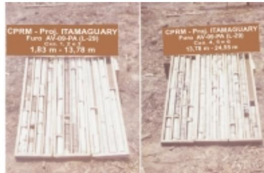
**Foto 7** – Caixas com testemunhos, furo AV-09-PA
