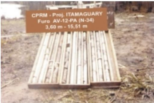
**Foto 6** – Caixas com testemunhos, furo AV-12-PA
