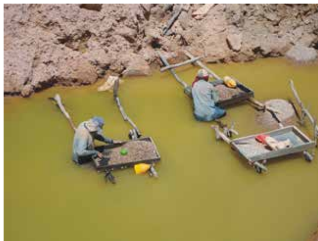
Foto 6.4 – Lavagem manual para separação da Opala – mina do Boi Morto.
