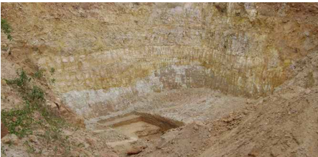
Foto 5.30 – Garimpo do Mamoeiro – cava onde se observa o pacote de rochas sedimentares da Formação Cabeças sobrepostas ao nível argiloso na base da sequência, onde se encontra aberta a cava com forma quadrada a retangular (foto feita em agosto/2010). Em 2011/2012 essa cava foi totalmente preenchida por rejeitos.
