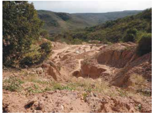
Foto 5.15 – Mina do Boi Morto – vista da estrada, quando se chega à área lavrada da mina, em direção ao rio dos Matos. Essa foto chama a atenção para a quantidade de material escorregado e/ou desmontado das frentes de lavra, somado às pilhas de rejeito.
