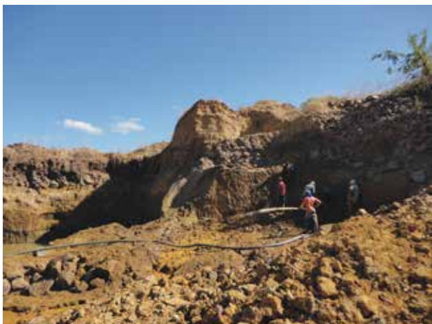
Foto 5.23 – Garimpo da Roça – desmonte hidráulico do capeamento para acessar o nível argiloso produzido da alteração do diabásio sotoposto (mesmo local da foto anterior, porém esta foto foi realizada em agosto/2013).
