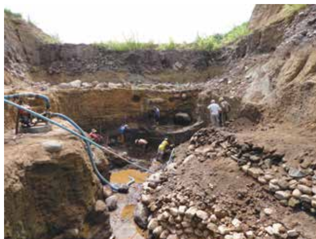
Foto 5.22 – Garimpo da Roça – aprofundamento de cava para extração de opala no nível argiloso (maio/2013).
