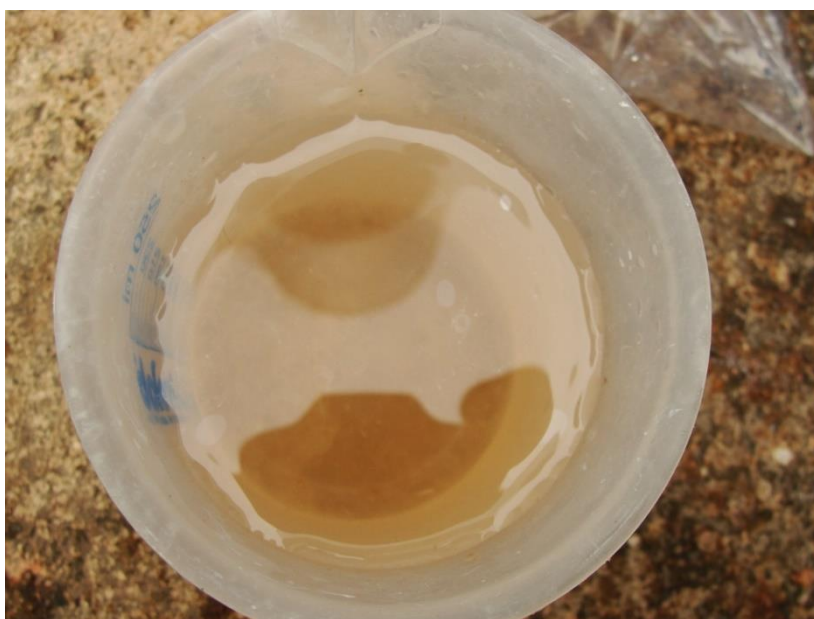
Figura 21 – Amostra de água retirada de posto de gasolina, evidenciando manchas de óleo na superfície da água.
