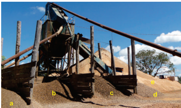
Figura 4.3 - Classificação granulométrica de agregados do Rio Tocantins. a, b, c e d representam as graduações de seixos 0, 1, 2, e 3, respectivamente. Em "e" está a areia não classificada.
