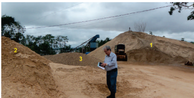
Figura 4.4 - Agregados classificados separados em pilhas de areia grossa (1), areia média (2) e seixos (3), nas margens do Rio Tocantins.
