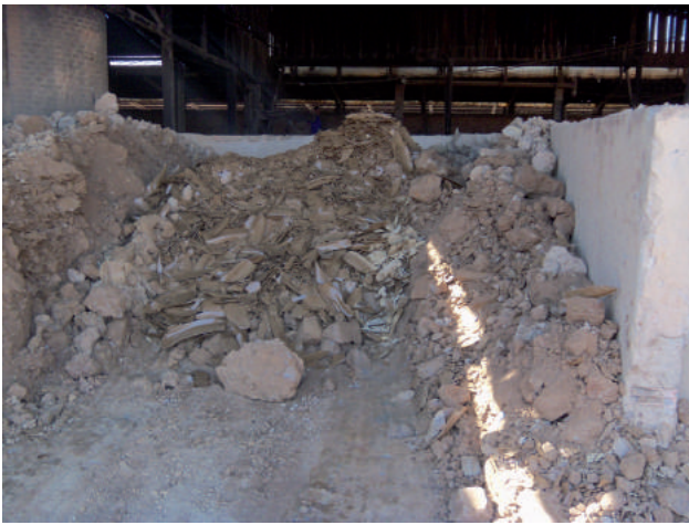
Figura 4.17—Caixa de alimentação com argila in natura misturada com restos de material extrudado irregularmente e reaproveitados.
