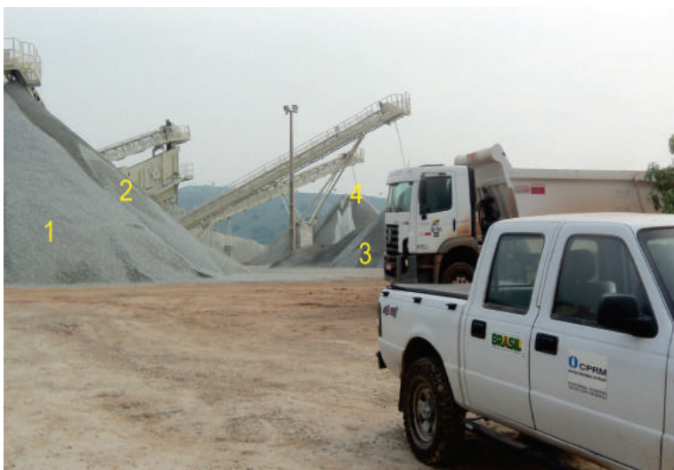
Figura 4.22 - Pilhas de produtos britados expostos no pátio de estocagem da mina. (1) Brita nº 2; (2) Brita nº 1; (3) Brita nº 0; (4) Pó-de-Brita.
