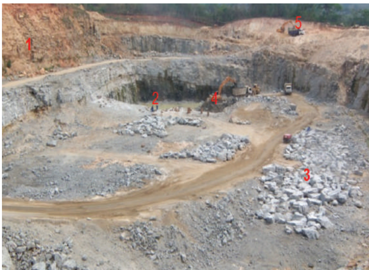
Figura 4.21 – Mina de brita do município de Eldorado dos Carajás. 1 - Regolito; 2-Frente de lavra; 3-Blocos e matacões de rochas produzidos pelas detonações; 4 - Escavadeiras de esteira em operação abastecendo caçamba de 15 toneladas; 5-Cavadeira de esteira em operação na retirada do estéril (regolito).
