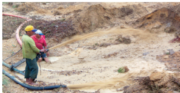
Figura 4.11 - Desmonte hidráulico do depósito de terraço da margem direita do Rio Vermelho (Sítio Prainha).
