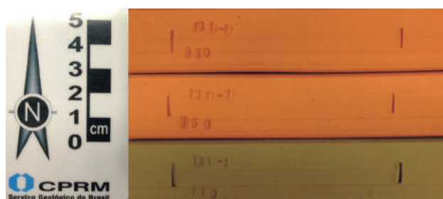
Figura 3.14 - Exemplo do corpo de prova nas temperaturas de 110°, 850° e 950° C mostrando variações de cores de queima.
