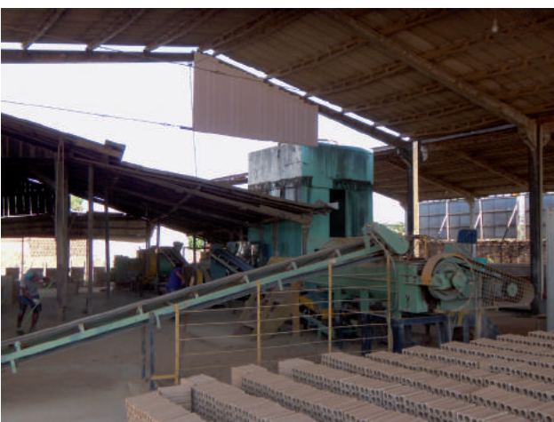
Figura 4.19 - Correia transportadora de material vindo do desintegrador para o misturador.
