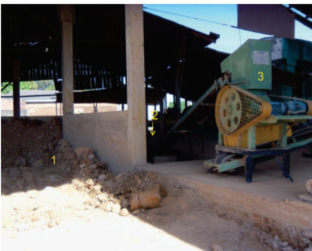
Figura 4.18. - Correia transportadora de argila fragmentada vinda do destorroador (2) e desintegrador (3).
