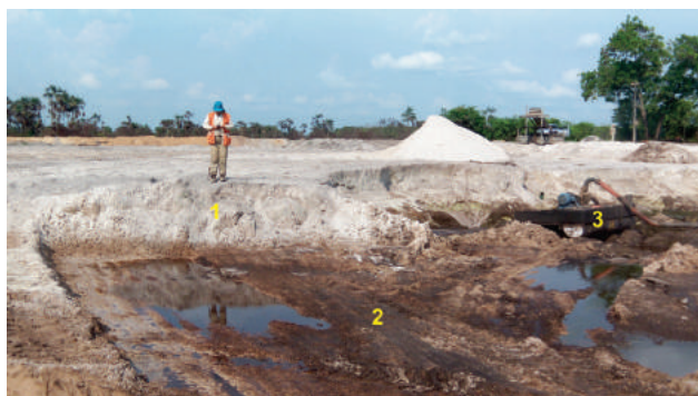
Figura 4.9 - Foto mostrando a extração de areia branca em cava seca, exibindo o Horizonte Eluvial E de interesse (1), o Horizonte Espódico B e o nível superior do lençol freático (2) e bomba de sucção (3).
