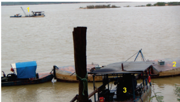
Figura 4.1 - Dragagem de agregados no leito do Rio Tocantins (1); Barcaça de transporte de agregados (2); Bomba de sucção utilizada para direcionar os agregados para classificação granulométrica (3).
