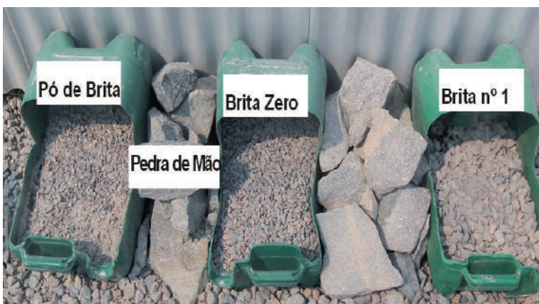
Figura 4.23 - Pilas de britas produzidas.
