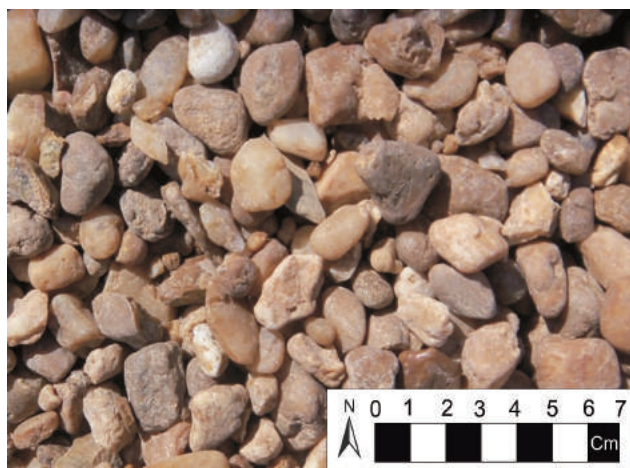
Figura 3.2 - Detalhe de seixos de graduação nº 1 referente à amostra JG-01A.
