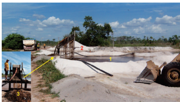
Figura 4.10 - Exploração em fase de cava submersa. (1) Bacia de acumulação de areia lavada; (2) Pilha de areia branca lavada pronta para carregamento e comercialização; (3) Detalhe do operador responsável pela retirada de impurezas do material.
