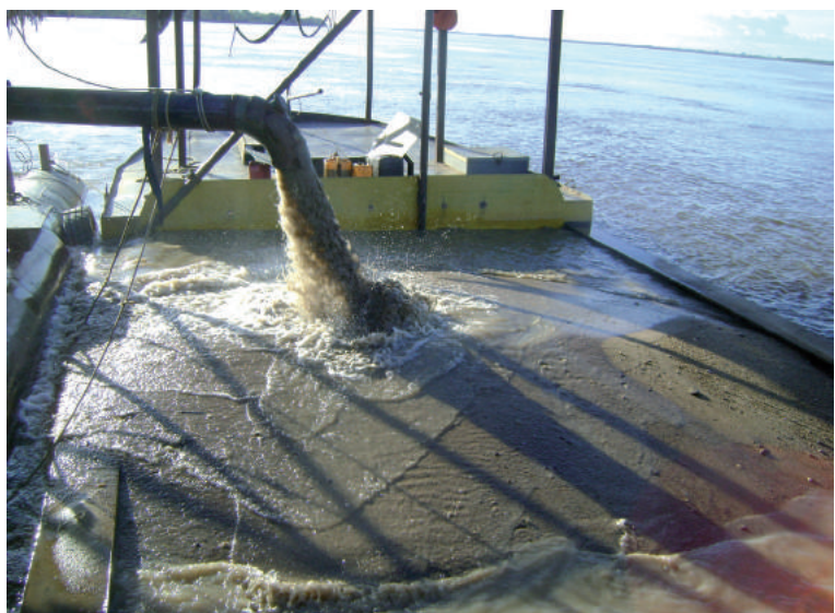
Figura 7.2 - Carregamento da barcaça com agregados (areia e seixos) extraídos por sucção do leito do Rio Tocantins, para ser classificado e estocado na margem do rio. A atuação contínua e descontrolada de tal processo de extração pode provocar desequilíbrio do regime do rio.
