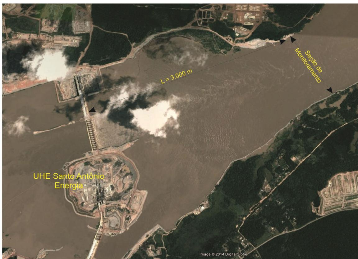
Figura 9 – Seção de monitoramento próxima à UHE Santo Antônio Energia.
