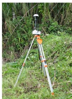
(d) GPS-RTK instalado na margem do rio.
