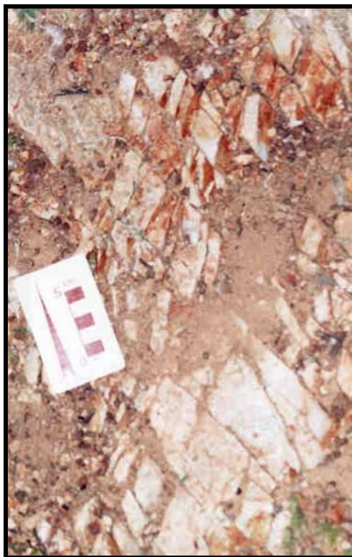
Fotografia 9 - Veio de quartzo muito fraturado em zona de cisalhamento dúctil-frágil N-S.
