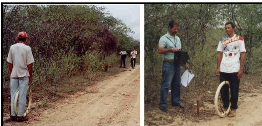
Fotografia 14 – Equipe de campo na execução de levantamento eletromagnético com Geonics EM34 (dipolo horizontal) nas proximidades da lagoa do Farias.
