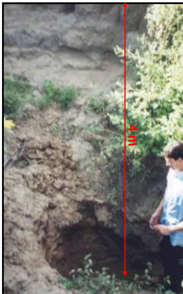
Fotografia 8 - Cacimba escavada no leito do riacho Santa Rita em aluviões arenosas com água.
