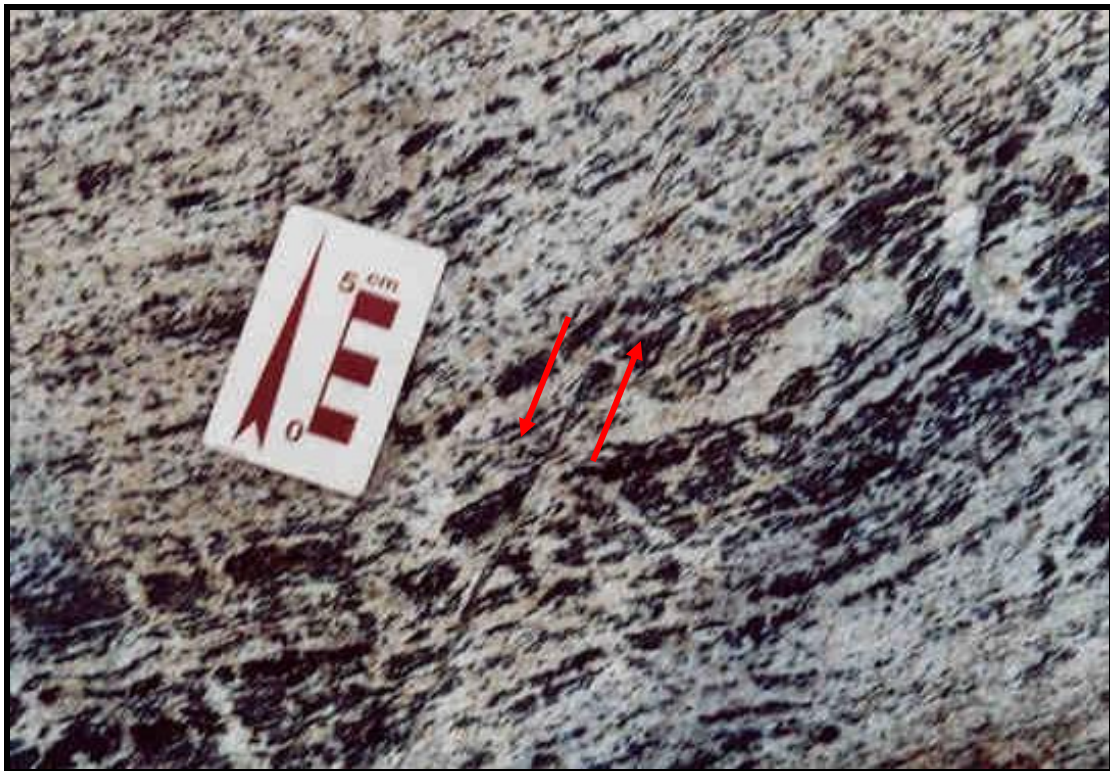
Fotografia 4 - Falha dúctil-frágil N-S, com movimento sinistral, afetando ortognaisses bandeados.
