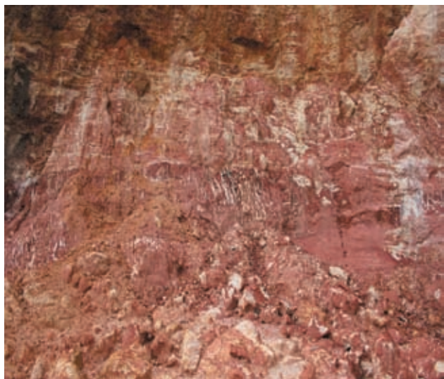
Figura 11.12 – Vista parcial de unidade rochosa com fraturamento moderado, em disposição estrutural horizontal; camada rochosa pouco consolidada, com alguma incoerência e impermeabilização; a textura e estrutura mostram tendência à erosão laminar.
