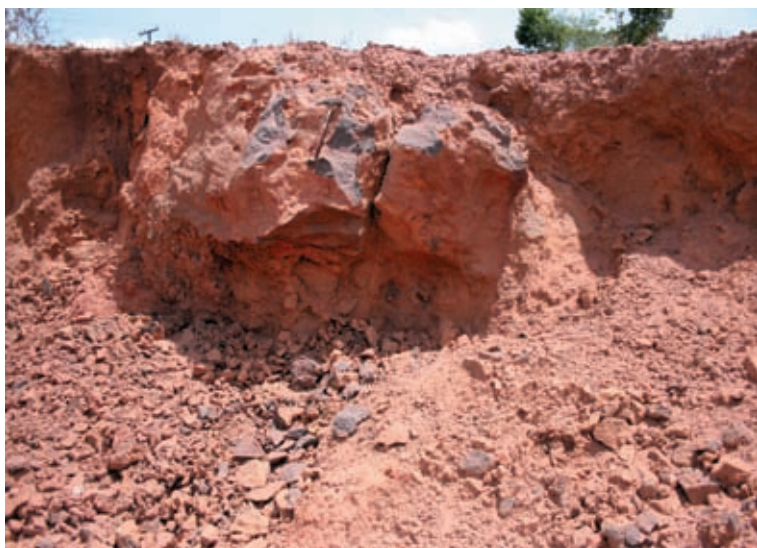
Figura 11.7 – Espessa crosta laterítica ferruginosa com formação in situ , extraída para utilização imediata na construção civil.
