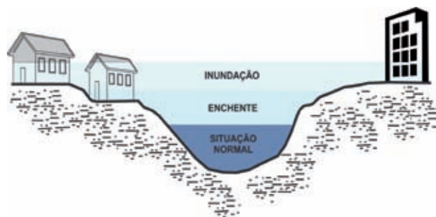
Figura 8.8 – Perfil esquemático do processo de enchente e inundação. Fonte: Brasil (2007).
