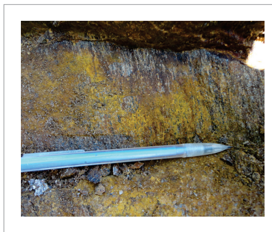
Figura 24 - Formação ferrífera bandada (BIF) com foliação/bandamento com atitude 000°60' (mergulho de 60° para 090°).
