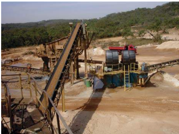
Foto 6.6 – Produção de areia a partir da moagem de quartzitos, município de Senador Canedo.
