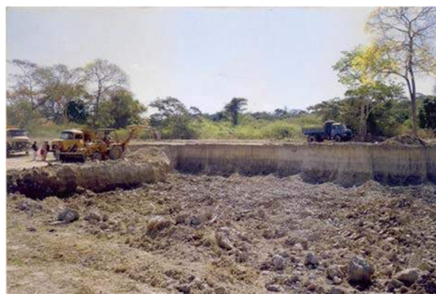
Foto 7.8 – Lavra de argila executada em tiras, com bom critério técnico, município de Silvânia.
