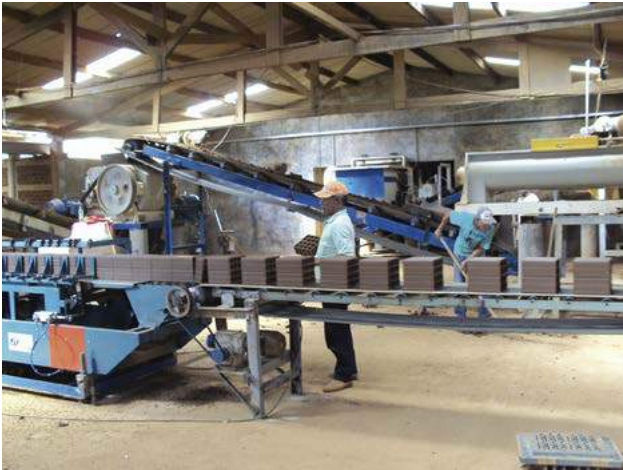
Foto 6.10 – Instalação para produção de tijolos furados, cerâmica no município de Anápolis.
