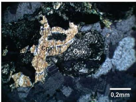
Foto 3 ppx. Clinopiroxênios e ortopiroxênios se distinguem pelas cores de interferência e ângulos de extinção.
