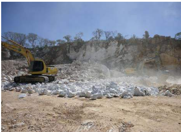
Foto 7.14 – Lavra de calcário com geração de material particulado, município de Indiara.
