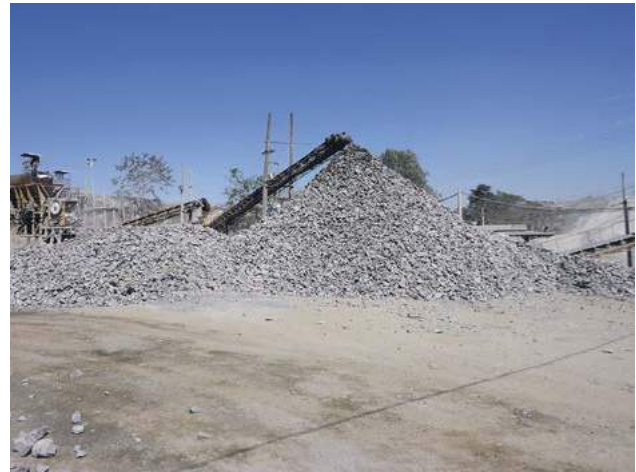
Foto 5.4 – Instalações de britagem de mica xisto, município de Aparecida de Goiânia.
