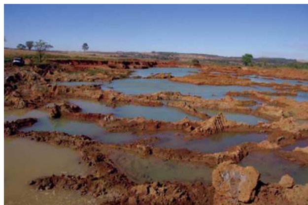
Foto 7.9 – Lavra executada de forma aleatória, sem a devida recuperação ambiental, município de Anápolis.
