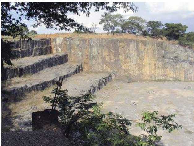
Foto 7.13 – Lavra de mica xisto para produção de brita, com bancadas regulares, município de Aparecida de Goiânia.
