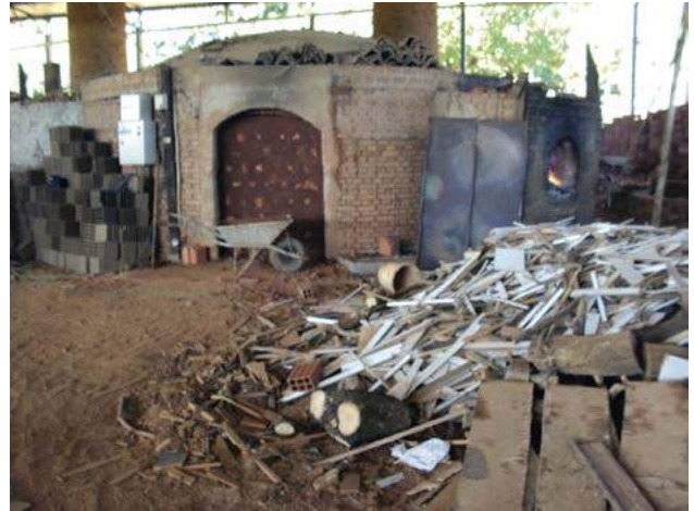
Foto 6.12 – Forno usado na queima dos produtos, cerâmica localizada em Anápolis.
