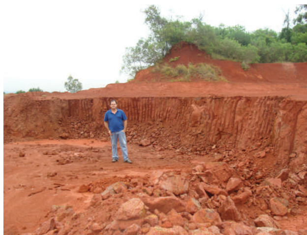
Figura 4.14 – Frente de lavra de argila para cerâmica vermelha com espessura em torno de 3,0 metros em Costa do Ipiranga no município de Gravataí.
