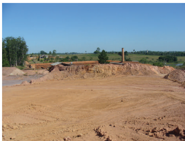
Figura 4.15 – Frente de lavra de argila para cerâmica vermelha com espessura em torno de 3,0 metros em Rincão da Madalena no município de Gravataí.
