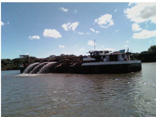
Figura 6.1 – Draga de sucção removendo areia do Rio Jacuí (Foto: Geol. Ivan Luis Zanetti).
