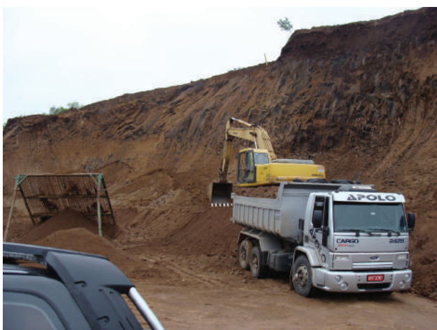
Figura 5.11 – A expedição e o transporte de minério envolvem o uso de maquinário como retroescavadeiras, pás-carregadeiras e caminhões. A operação deste maquinário é potencialmente responsável pela emissão de gases, poeiras, produção de ruídos e vibrações, trazendo como impactos a redução da qualidade do ar, o afugentamento da fauna e incomodo à vizinhança. Ponto GP-083.
