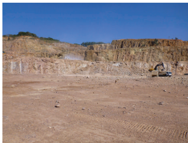
Figura 6.12 – Extração de granito para brita em pedreira organizada em bancadas.
