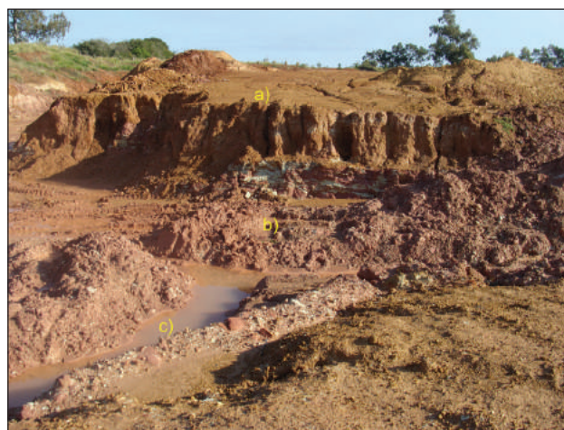
Figura 5.2 – Remoção de solo e cobertura vegetal em mina de argila vermelha ilustrando diversos impactos ao meio físico: a) aumento da erodibilidade evidenciado pela formação de ravinas no topo e face do talude; b) diminuição da taxa de infiltração das águas pluviais evidenciado pelo seu acúmulo na praça de mineração; c) escoamento águas acumuladas transportando os sedimentos disponibilizados pela erosão, podendo acarretar no aumento do assoreamento das drenagens localizadas a jusante da mina. Ponto GP-129.
