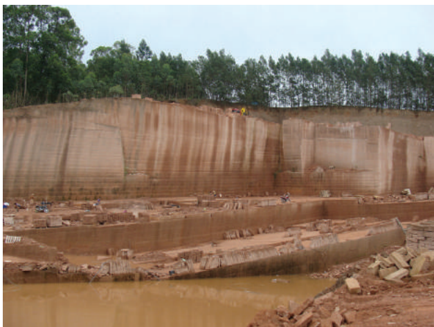
Figura 5.6 – Paredão com altura de aproximadamente 20 metros em mineração de arenito para pedra de talhe. Nota-se a total modificação da topografia e perda da harmonia paisagística com a geração de impacto visual. Adicionalmente, verifica-se a interceptação das águas subterrâneas na praça de mineração, deixando-as potencialmente expostas à ação contaminante. Ponto GP-022.
