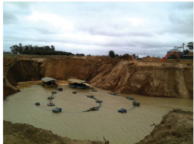
Figura 4.8 – Dragas flutuantes em ação nas lavras da planície costeira (Sistema Laguna-Barreira I). No detalhe é observada cava sendo minerada abaixo do nível freático.
