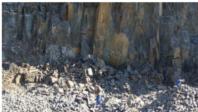
Figura 4.36 – Extração de basalto para pedra de talhe por desmonte manual. Ponto GP-056, Município de Capela de Santana.
