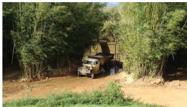
Figura 5.9 – Mineração de areia em leito de rio (ao fundo) com descarregamento de minério na margem. A areia misturada com a água do rio é bombeada diretamente para a caçamba do caminhão e o excedente retorna livremente para o curso d'água aumentando localmente a turbidez da água. Ponto GP-178.
