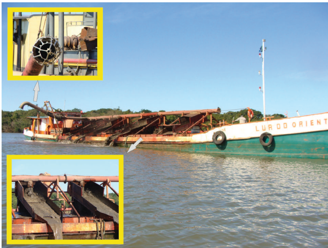
Figura 4.4 – Draga flutuante embarcada em ação no baixo Jacui. No detalhe, são observados a ponta de sucção da draga, e o sistema de peneiramento para retirada da fração cascalho da carga arenosa do leito do rio.
