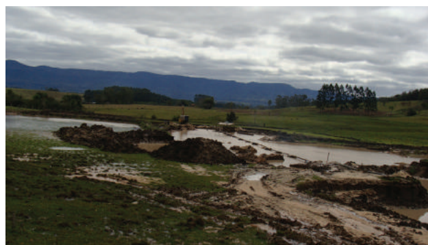
Figura 4.6 – Lava de areia em planície aluvial da bacia do rio dos Sinos. No detalhe é observado o ponto de lava com operação de pequena draga em cava inundada.
