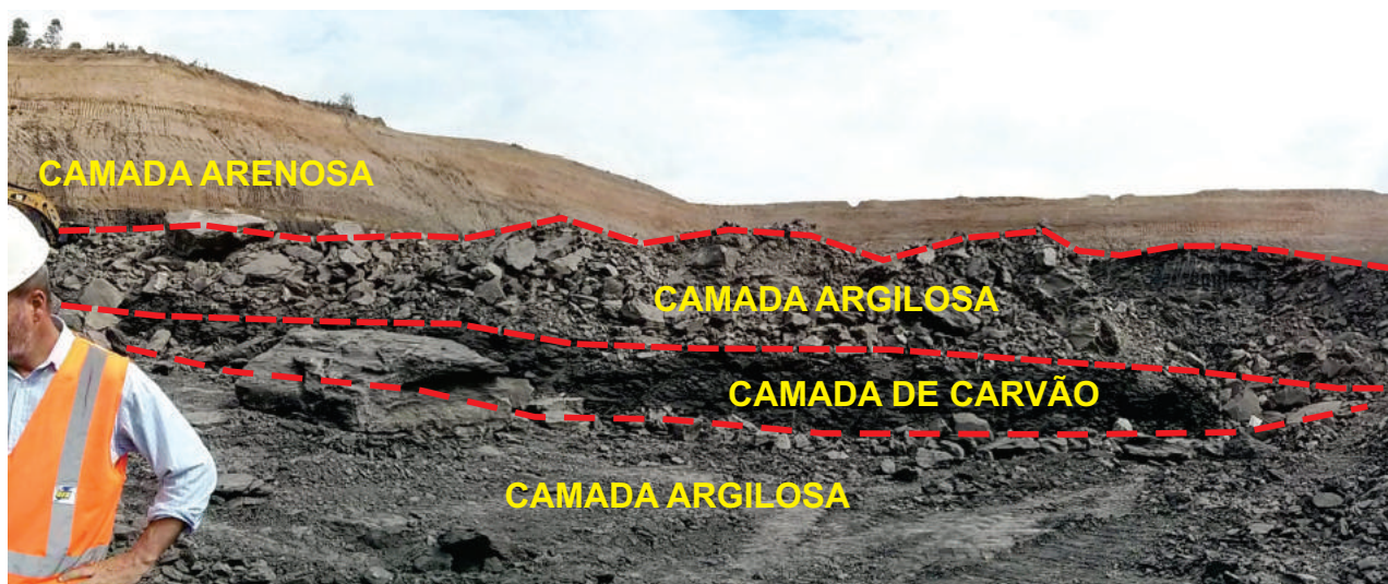
Figura 4.11 – Mina de carvão a céu aberto em Arroio dos Ratos. No detalhe é observada as camadas de argila e areia (rejeitos) na frente de lavra local. A camada de carvão é visualizada em pequena trincheira.
