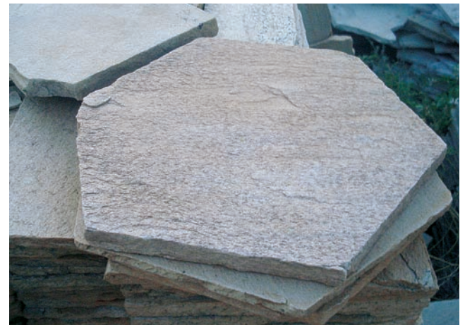
Figura 124 - Peças de revestimento elaboradas em quartzitos e produzidas na região.
