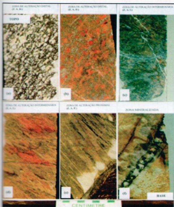
Figura 11. Perfil vertical da zona de alteração desenvolvida em granitóide sob condições de P-T consistente com as condições de fácies anfibolítica de baixo grau, local: garimpo Ouro Roxo. Observar do topo para a base: (a) rocha encaixante (tonalito); (b) zona de alteração distal (potássica) rica em K-feldspato rosa; (c) zona de alteração distal pobre em K-feldspato associado à sericita, quartzo e clorita; (d) zona de alteração proximal formada por sericita, clorita e carbonato com textura milonítica; (e) zona de alteração proximal consistindo de clorita e carbonato e textura milonítica muito fina; (f) zona mineralizada com veio de quartzo com sulfeto e ouro.
