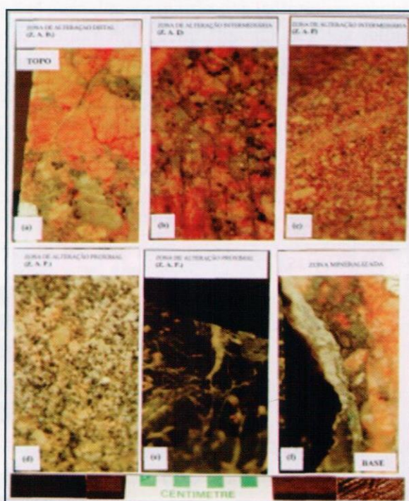
Figura 12. Perfil vertical da zona de alteração desenvolvida em granitóide sob condições de P-T consistentes com as condições de fácies greenschist, local: garimpo "mineração" Crepori, área do Creporizão. Observar, do topo para a base: (a) rocha encaixante, granitóide; (b) e (c) zonas de alteração distal rica em feldspato rosa (microperfitas) associado a minerais filossilicáticos (muscovita e clorita) com textura cataclástica; (d) zona de alteração proximal com matriz afanítica de quartzo, feldspato, plagioclásio, clorita, muscovita e carbonato; (e) amostra de andesito (rocha encaixante) que ocorre em contato com a mineralização; (f) zona mineralizada desenvolvida no contato andesito (esquerda, cor escura) / granito (direita, cor rosa claro), consistindo de veio de quartzo portador de ouro e sulfetos.
