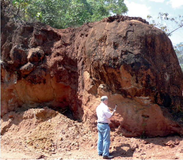
Figura 6.25 - Blocos e Bouders de rocha granodiorítica exibindo esfoliação esferoidal em meio ao saprolito e solo. Aspecto limitante à engenharia, sendo necessário a utilização de explosivo e maquinários para seu desmonte (Calçoene – AP). Fotografia: Acervo do projeto, 2011.
