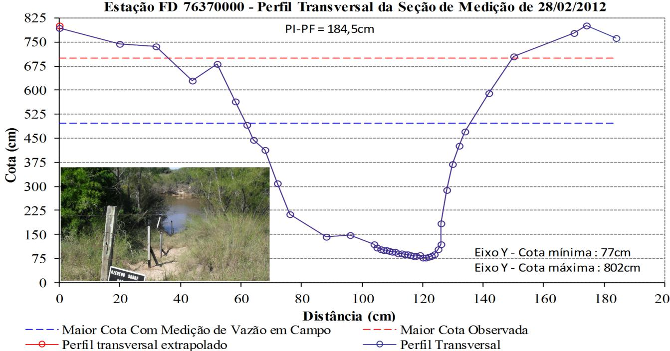
O perfil transversal (Figura) utilizado data de 28/02/2012, com distância entre o ponto inicial (PI) e ponto final (PF) de 184,5 metros, cota mínima de 77cm e cota máxima de 802cm. A maior vazão medida na série histórica da estação 76370000 foi em 22/10/2014, com 100m³.s⁻¹ e uma cota de 498cm (Figura). Já a menor vazão medida foi de 0,393m³.s⁻¹ e uma cota de 94cm, em 01/06/2012. A maior cota observada em campo foi de 699cm, em 05/10/2005.
