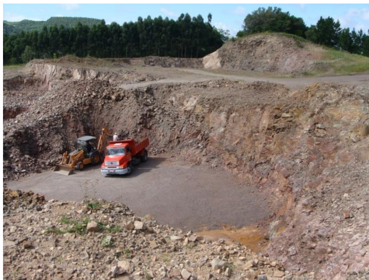
Figura 70 - Frente de lava para material de empréstimo (saibro/rachão) na região da Folha Sobradinho.
