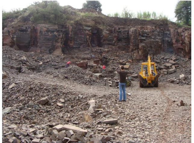
Figura 25 - Dacito em pedreira ativa da Fácies Caxias localizada próxima a cidade de Salto do Jacuí. No local são preparados blocos, chapas e paralelepípedos para construção civil.
