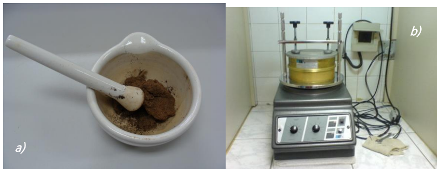
Figura 73 - a) Gral de porcelana para desagregação das amostras; b) Agitador de peneiras vibratórias eletromecânicas tipo ROTAP.
