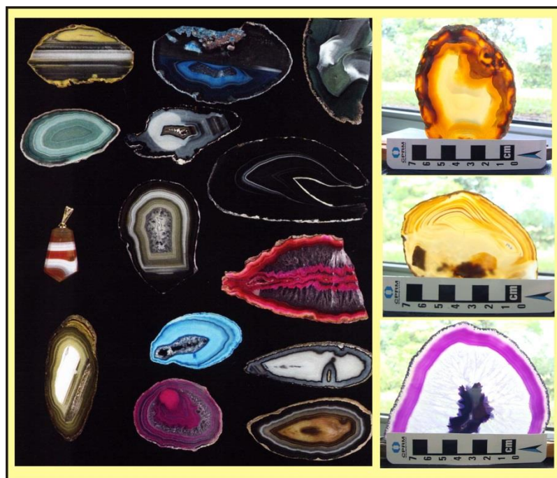
Figura 66 - Variedades de ágatas beneficiadas com tingimento e polimento. No lado esquerdo, a maioria das amostras sofreu processo de tingimento. No lado direito, somente a amostra do canto inferior direito (roxo) está tingida (figura modificada de BRANCO & GIL; 2002).
