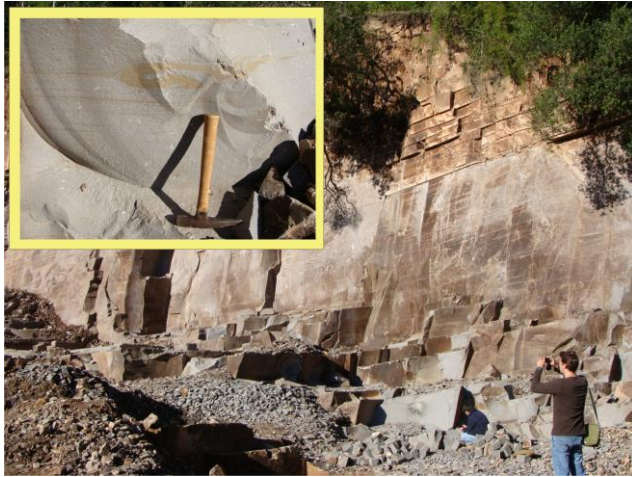
Figura 24 - Dacito em pedreira ativa da Fácies Caxias localizada próxima a cidade de Sobradinho. No detalhe é visto a coloração cinza homogênea, por vezes, com tingimento de óxidos marcando fluxo vulcânico. No local são preparados blocos e paralelepípedos para construção civil.
