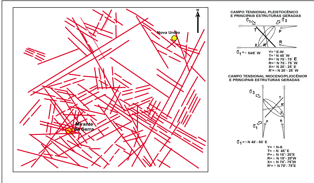
Figura 3 - Município de Mirante da Serra, mapa de lineamentos foto-interpretados (Escala 1:100.000) e campos tensionais responsáveis pela geração das principais estruturas.
