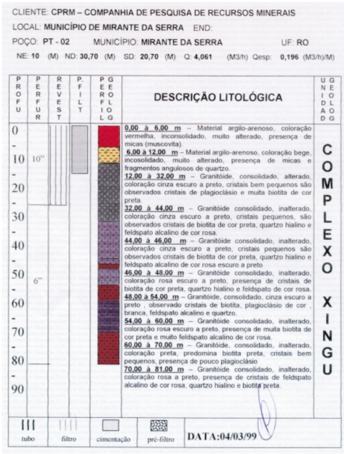
Figura 17 - Perfil litológico do poço perfurado (Pt02)
