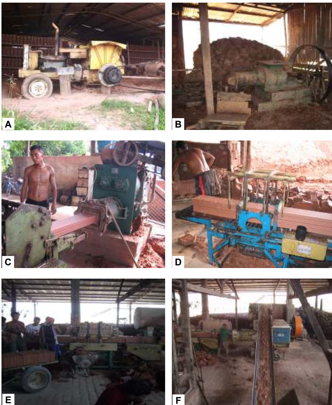
Figura 12.12 – Extrusão: (A e B) Extrusora simples usada pelas micro indústrias (Manaquiri-Castanho); (C e D) Equipamento de extrusão a vácuo e corte geralmente usado pelas pequenas e micro indústrias da região de Manacapuru-Iranduba; (E e F) Extrusora a vácuo utilizado pelas indústrias mais equipadas (região Manacapuru-Iranduba).
