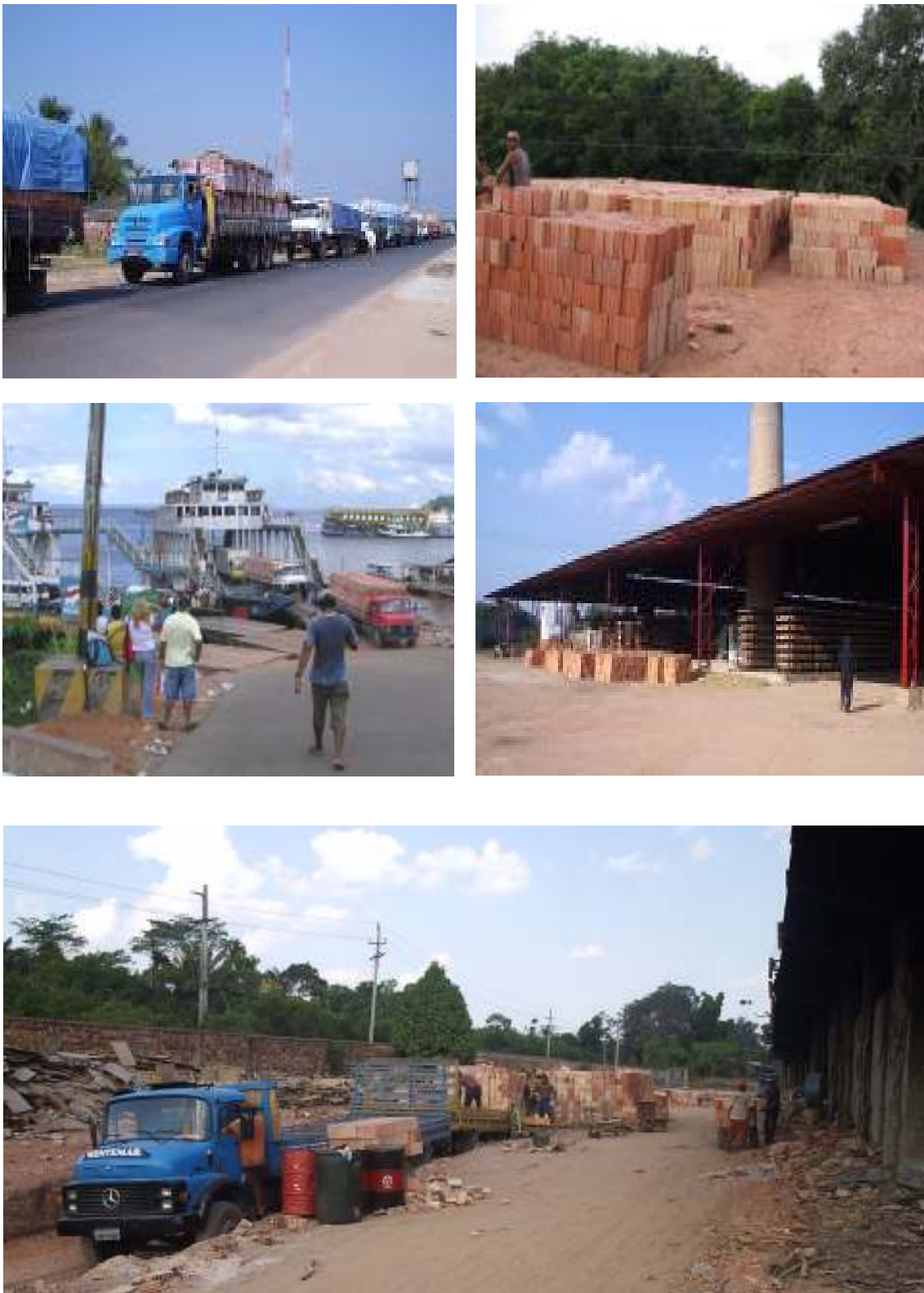
Figura 12.15 – Expedição: (A e B) Os caminhões utilizados trafegam, em média, com 10 milheiros de tijolos; (C e D) Armazenamento no pátio da fábrica, para pronta entrega; e (E) Carregamento para entrega.
