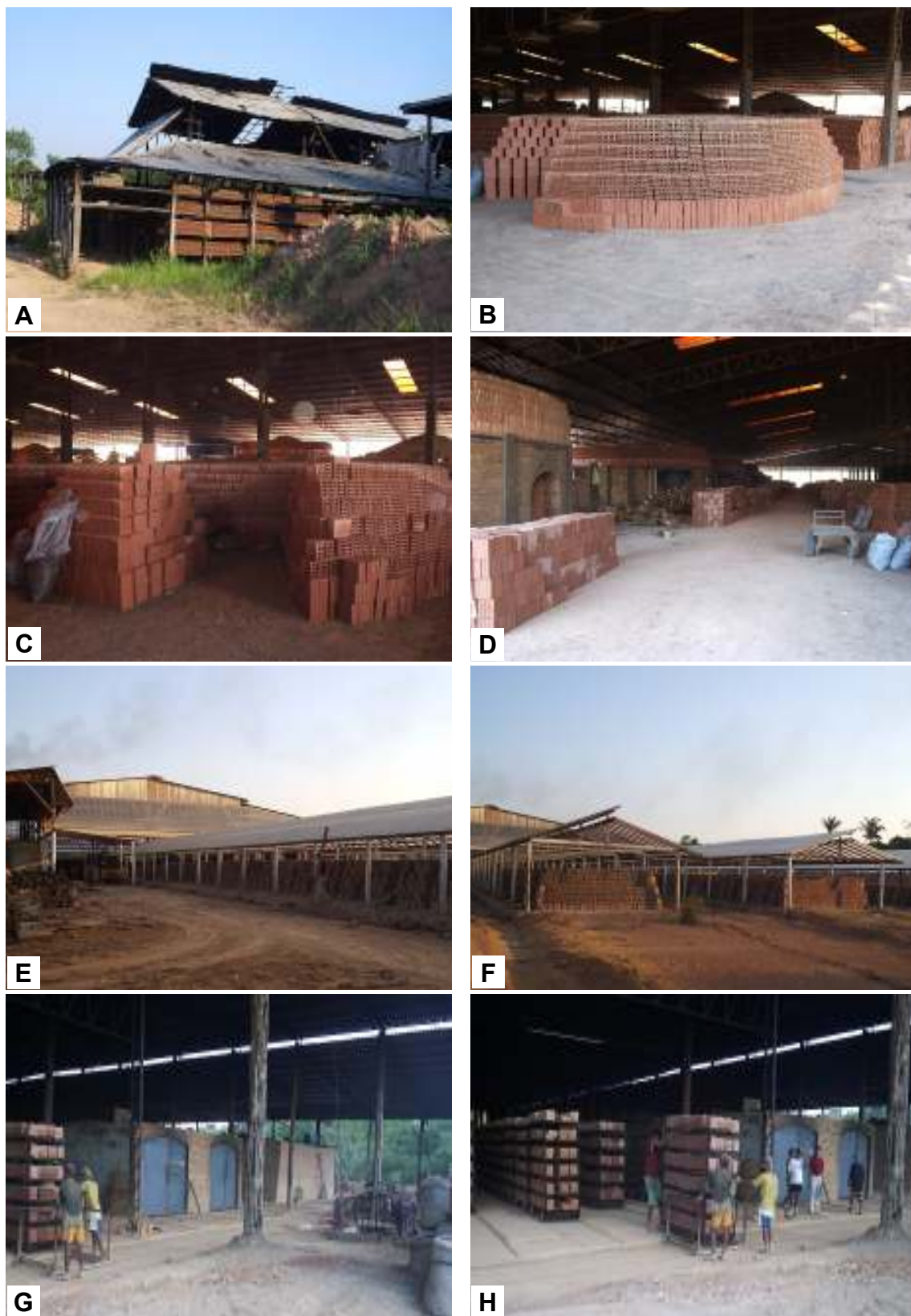
Figura 12.13 – Secagem: (A) Secagem natural rudimentar; (B, C e D) Secagem natural organizada; (E e F) Secagem natural em estufa; (G e H) Secagem artificial com secadores.
