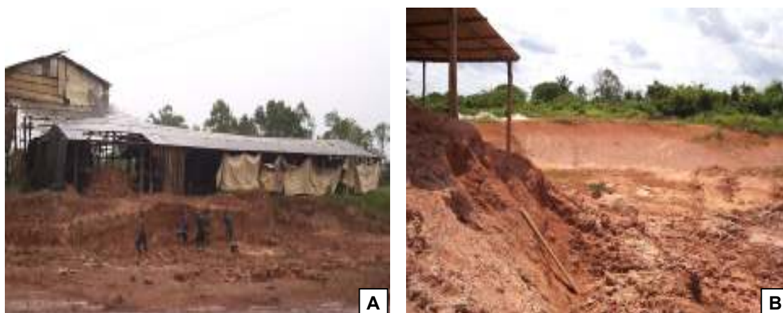
Figura 12.9 – Barreiros no próprio terreno da olaria, freqüente nas micro indústrias: (A) Extração manual em Manaquiri, (B) Cava para extração de argila através de pá mecânica (Careiro do Castanho).
