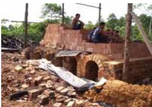
Figura 13.4 – Perda ocasionada por deficiência na gestão da produção e armazenamento do tijolo. Micro-indústria localizada em Manaquiri (AM).
