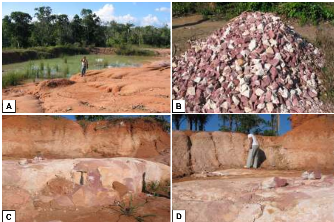
Figura 7.7 – (A) Antiga exploração de brita desenvolvida sobre a fácies “Arenito Manaus” no baixo curso do igarapé Cachoeira no Município de Iranduba (morfofounidade Kac II); (B) Brita de arenito silicificado; (C) Detalhe do nível de arenito silicificado (na base); (D) Capeamento estéril de 1,50m de arenito argiloso alterado, friável sobre o arenito silicificado.
