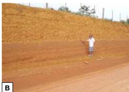
Figura 7.8 – Km 12 da AM-254. (morfounidade Kac II). (A) Local de exploração de areia a partir de arenito alterado. (B) Camada de piçarra com até 1,0 m de espessura recoberta por latossolo amarelado.
