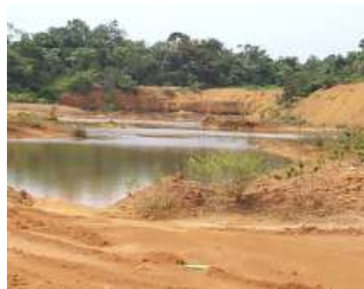
Figura 8.2 – Local de exploração de areia a partir de arenito intemperizado. No topo latossolo com nível de piçarra.
