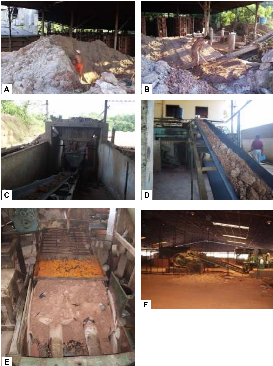
Figura 12.11 – (A e B) Processo de desintegração e alimentação manual empregado geralmente pelas micro indústrias; (C e D) Caixa alimentador e esteira de alimentação com detector de metais; (E) Equipamento simples para homogeneização e laminação da argila usado pelas pequenas indústrias; (F) Equipamentos mais sofisticados utilizados pelas cerâmicas de médio porte.
