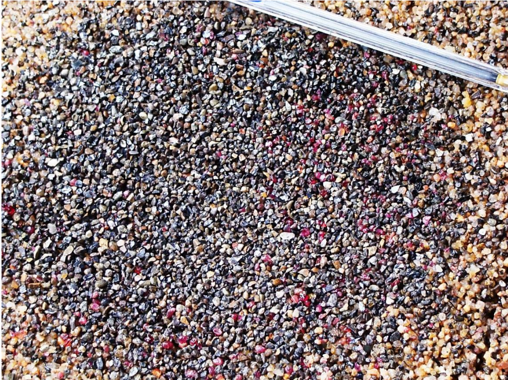
Foto 4.16 – A granada chama atenção nos concentrados de bateia pela sua coloração, principalmente violeta, onde pode somar cerca de 15%.
