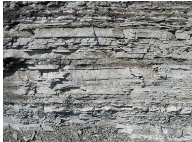
Foto 3.111 - Seqüência principal ('pacote econômico') de ocorrência de rochas carbonáticas da Formação Irati. Frente de Lavra Norte da Mineração Alto Garças. Alto Garças-MT.
