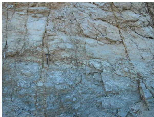
Foto 3.53 - Contato entre dolomito cinza (parte inferior) e dolorrudito (parte superior) na parte mediana do perfil.
