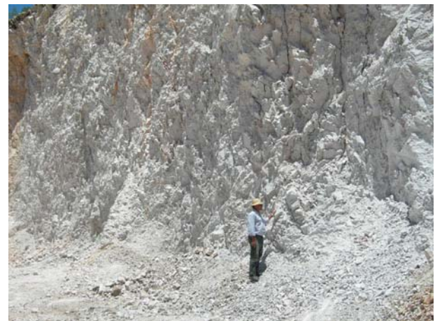
Foto 3.20 - Calcário dolomítico (dolomito) branco a bege com acamamento original obliterado pela deformação. Frente de Lavra Dolomítica - Calcário Carmelo. Cáceres-MT.
