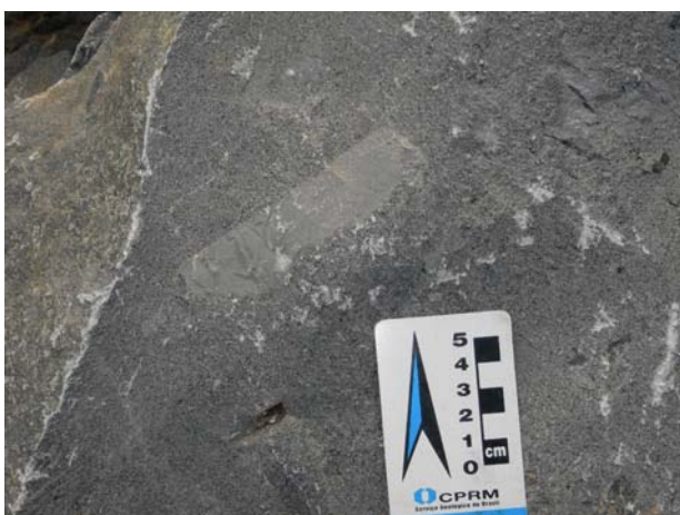
Foto 3.2 – Dolomito com intraclasto de calcário finamente cristalino. Calcário do Vale. Nova Xavantina-MT.
