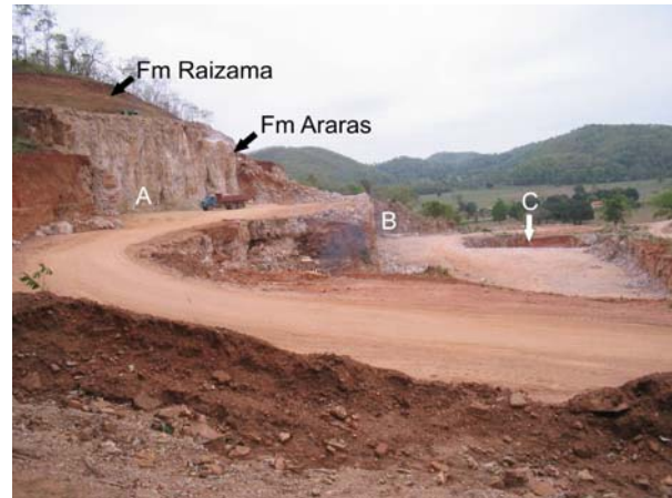
Foto 3.9 - Seqüência carbonática da Formação Araras (bancadas A, B, C) e sedimentos siliciclásticos da Formação Raizama. Império Minerações- Unidade Mirassol d'Oeste – Frente de Lavra Ativa. Glória d'Oeste - MT.
