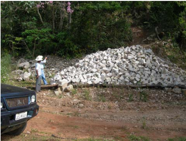
Foto 3.123 - Blocos de rocha para calçamento de vias, obtidos de camadas de quartzo-arenito laminado, carbonático. Sítio Flor da Serra, Distrito de Sonho Azul, Mirassol d'Oeste-MT.
