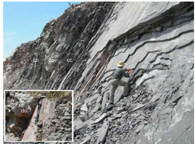
Foto 3.79 - Frente de Lavra Calcária com intercalação de lente de dolomito (do). Detalhe do contato de calcário (cc) e dolomito (do). EMAL – Unidade Açúcar. Nobres - MT.
