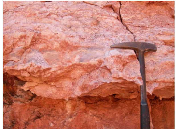
Foto 3.118 - Calcirrudito com zonas silicosas centimétricas, paralelos ao acamamento, e nódulos esbranquiçados calcíticos com formas amendoadas. Império Minerações –Unidade Poxoréu. Poxoréu-MT.
