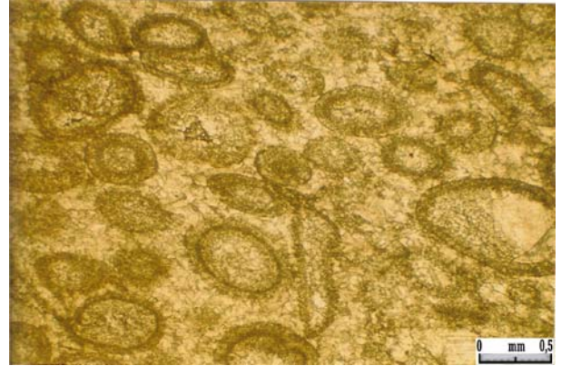
Foto 3.6 - Calcarenito oolítico (packstone a grainstone) com oólitos bem preservados e eventualmente policompostos. Amostra RM-R-31-1. Vanguarda Mineração, Nova Xavantina-MT.
