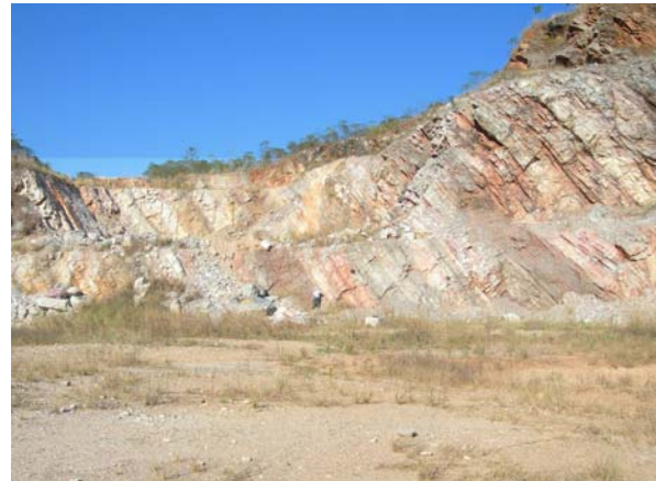
Foto 3.65 - Vista da parte superior da seção carbonática da mina Calcário Cuiabá. Camadas estruturadas em 50°E/50°NW de flanco de anticlinal regional. Calcário Cuiabá. Nobres-MT.
