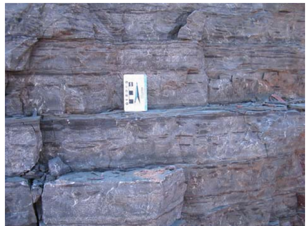
Foto 3.15 - Calcário regularmente estratificado e horizontal, com intercalações de delgados níveis de folhelho. Frente de Lavra "Pimenta". Calcário Tangará. Tangará da Serra-MT.
