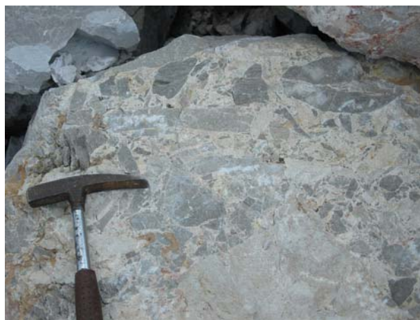
Foto 3.54 - Brecha com fragmentos de diferentes tipos de rochas carbonáticas cimentados por sílica (matriz?). Ecoplan- Frente de Lavra-P2. Nobres-MT.
