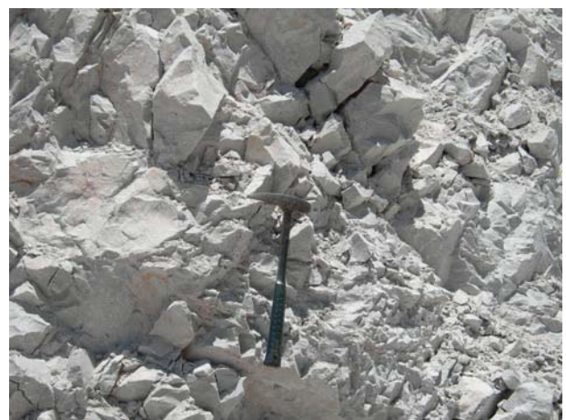
Foto 3.21 - Aspecto da intensa deformação com fraturas e cominuição de calcário dolomítico maciço branco a bege. Frente de Lavra – Dolomítica - Calcário Carmelo. Cáceres-MT.
