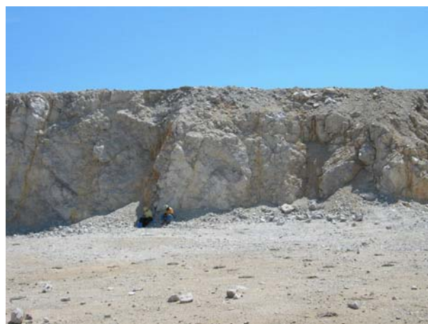
Foto3.55 - Frente de Lavra – P4 expondo camadas de calcário dolomítico com atitude média 50°- 65°NE/ 50°SE. ECOPLAN - Frente de Lavra P4. Nobres- MT.
