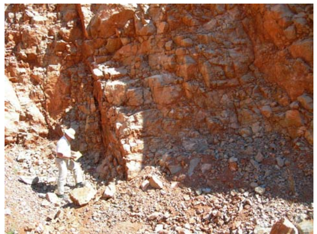
Foto 3.88 - Dolomito fraturado, localmente com acamamento original preservado (N35°-40°E/35°-40°SW). Império Minerações- Unidade Paranatinga. Primavera do Leste-MT.
