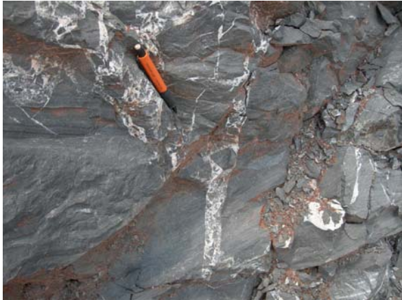
Foto 3.75 - Dolomito com brechas e fraturas preenchidas por sílica, localmente descaracterizando o acamamento. Votorantin – Calcário Itaú. Nobres-MT.
