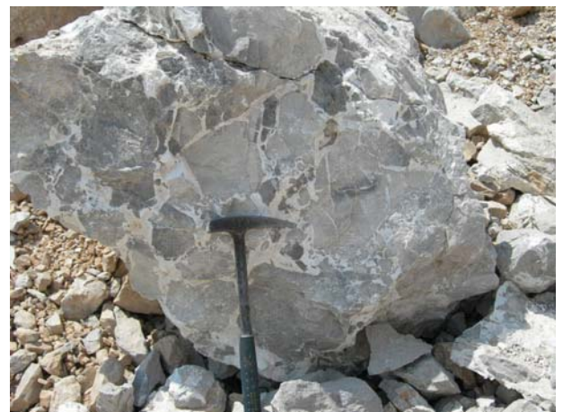
Foto 3.37 - Dolomito brechado com fragmentos angulosos envolvidos por vênulas de sílica. Império Minerações – Unidade Jangada. Rosário Oeste- MT.
