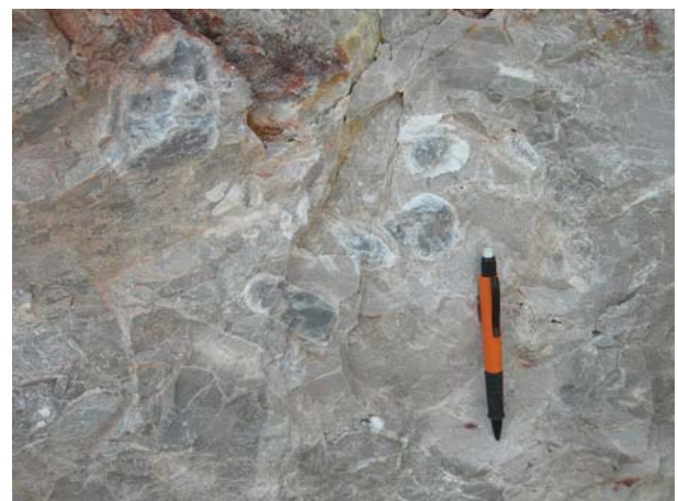
Foto 3.70 - dolarenito bege com nódulos de sílica e intenso fraturamento. Reical - Unidade Nobres. Nobres-MT.
