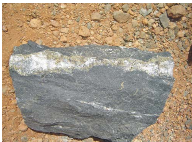
Figura 5.17 - Detalhe do veio quartzo sulfetado cortando a rocha básica milonitizada e hidrotermalizada. Observar os sulfetos no contato e entre o veio e rocha.
