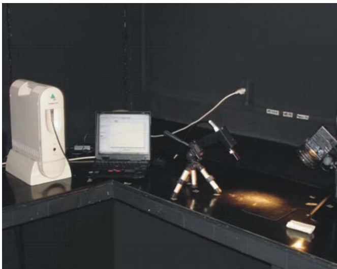
Figura 7.2 - Espectrorradiômetro utilizado para análise das amostras.
