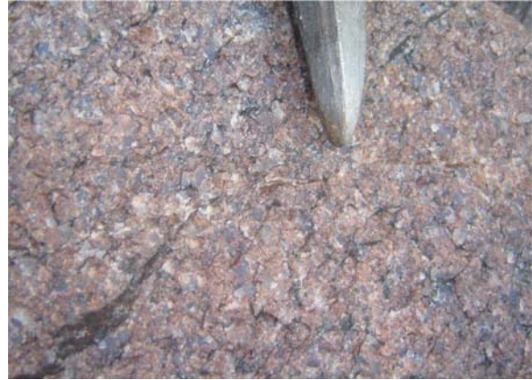
Figura 5.92 – Sienogranito isotrópico, grosso, cuja coloração vermelho tijolo deve-se ao processo de K-feldspatização, associado à hematitização.
