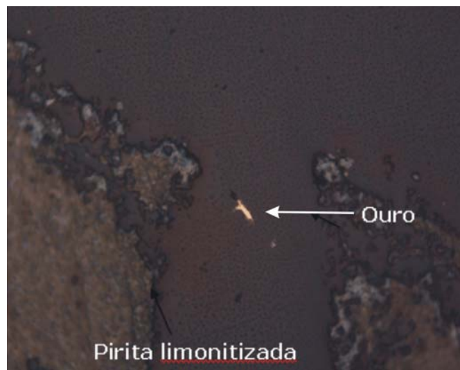
Figura 5.62 - Fotomicrografia de ouro livre no veio de quartzo. 20x, LR.
