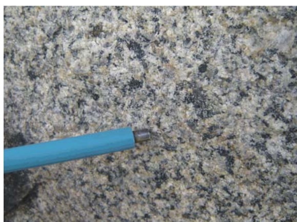
Figura 5.52 - Biotita granito isotrópico, médio a grosso da Suíte Paranaíta encaixante da mineralização aurífera no garimpo Pé de Fora.
