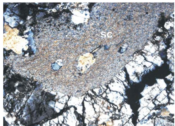
Figura 5.77 – Fotomicrografia de plagioclásio quase totalmente substituído por sericita (sc) em protomilonito do granitóide do garimpo do Edu (NX, 5x).
