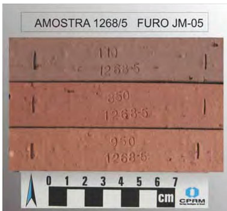
Figura 22 - Amostras do ensaio tecnológico do FURO JM-05, mostrando os blocos produzidos em diferentes temperaturas.
