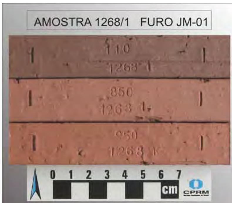
Figura 18 - Amostras do ensaio tecnológico do FURO JM-01, mostrando os blocos produzidos em diferentes temperaturas.
