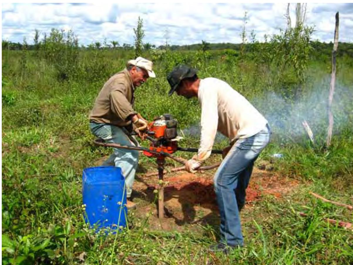
Figura 11 – Utilização do trado mecanizado na sondagem de argila.
