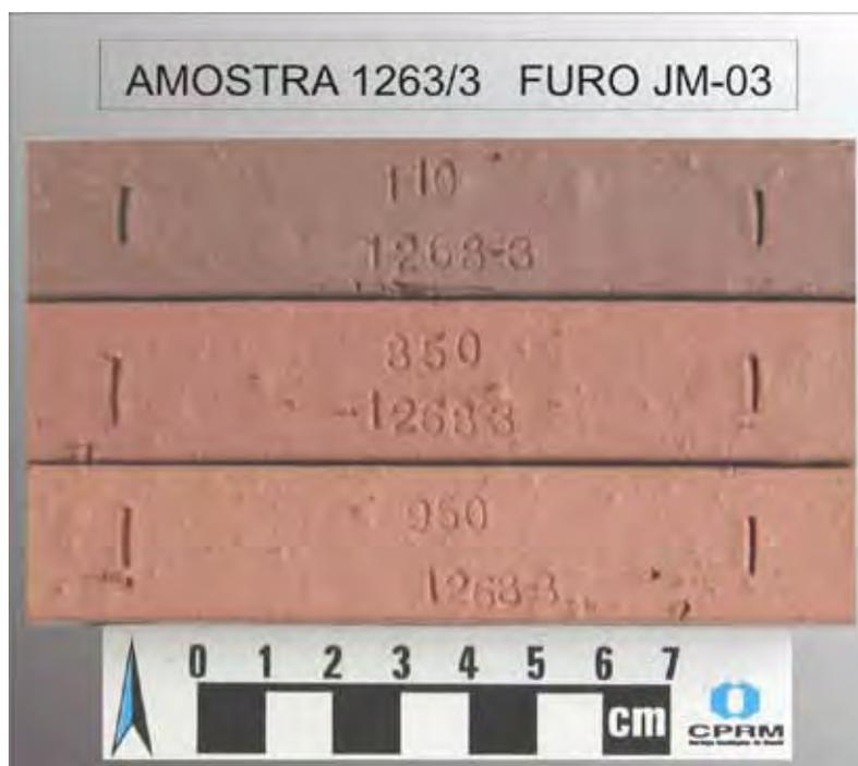
Figura 20 - Amostras do ensaio tecnológico do FURO JM-03, mostrando os blocos produzidos em diferentes temperaturas.
