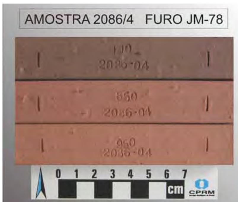
Figura 25 - Amostras do ensaio tecnológico do FURO JM-78, mostrando os blocos produzidos em diferentes temperaturas.
