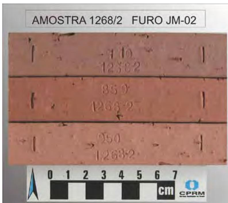
Figura 19 - Amostras do ensaio tecnológico do FURO JM-02, mostrando os blocos produzidos em diferentes temperaturas.
