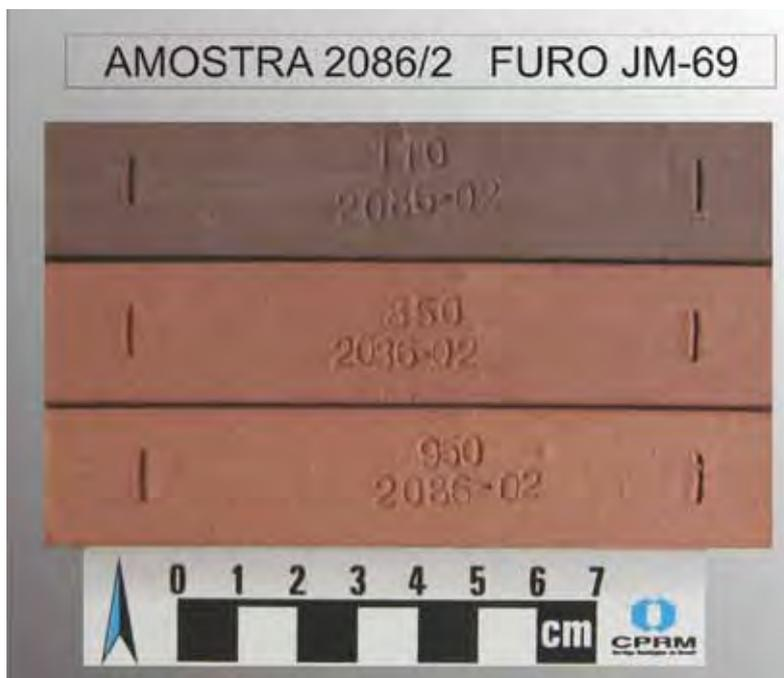
Figura 26 - Amostras do ensaio tecnológico do FURO JM-69, mostrando os blocos produzidos em diferentes temperaturas.
