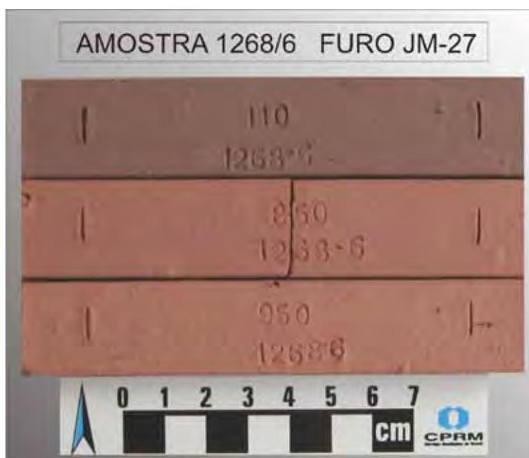
Figura 23 - Amostras do ensaio tecnológico do FURO JM-27, mostrando os blocos produzidos em diferentes temperaturas.
