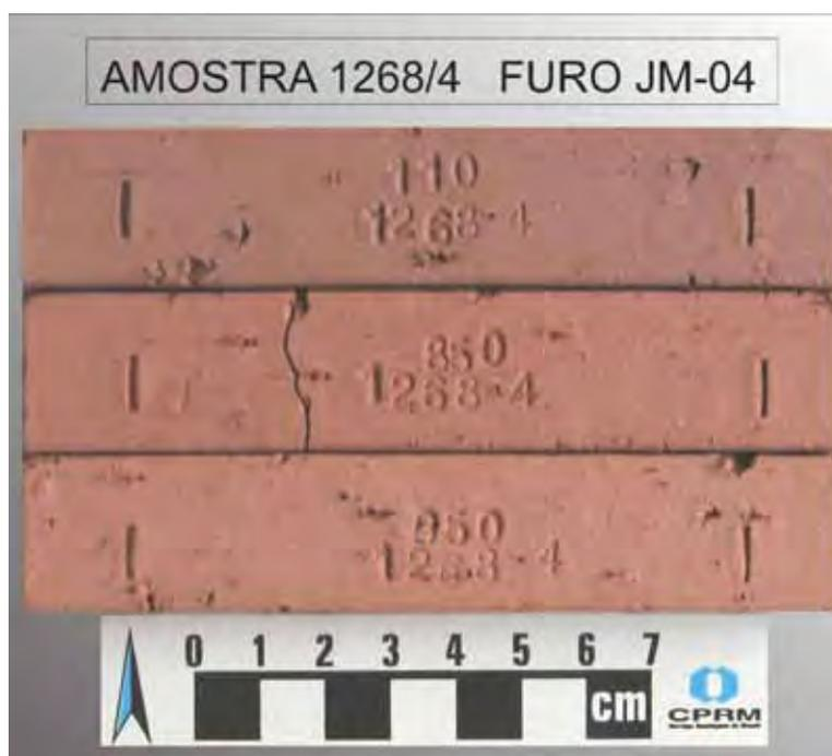
Figura 21 - Amostras do ensaio tecnológico do FURO JM-04, mostrando os blocos produzidos em diferentes temperaturas.
