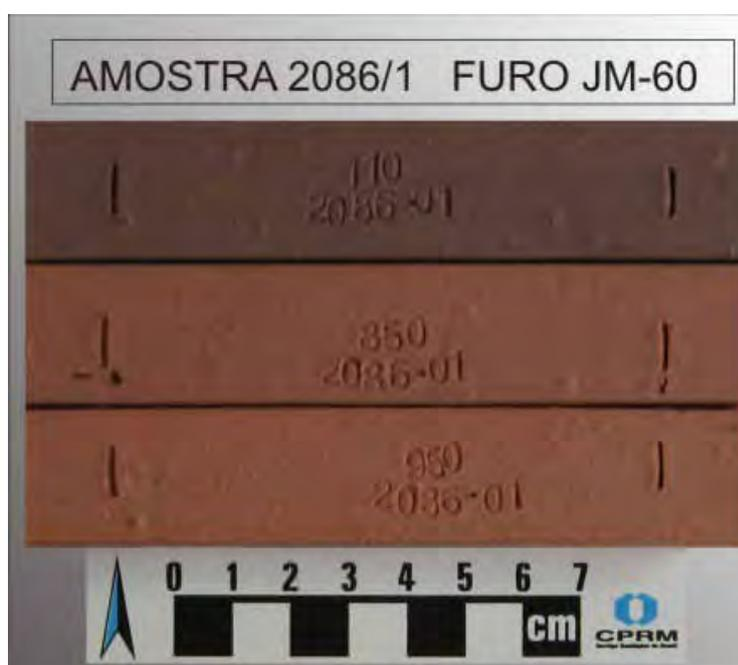
Figura 24 - Amostras do ensaio tecnológico do FURO JM-60, mostrando os blocos produzidos em diferentes temperaturas.
