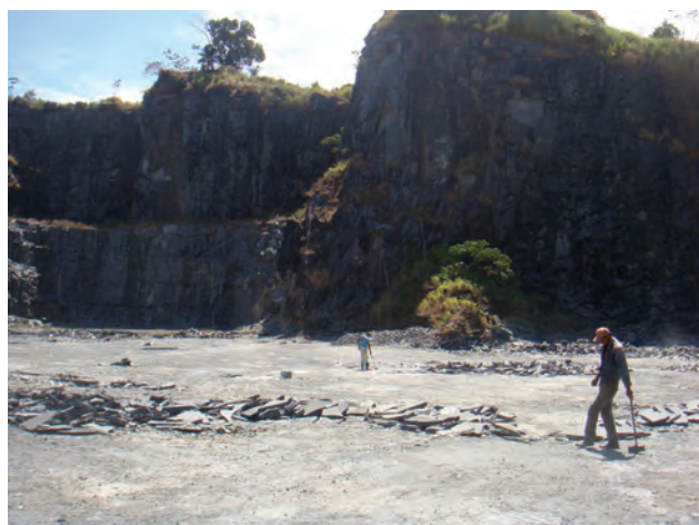
Foto 28 – Rebaixamento do piso de antiga pedreira (pedreira da Usibrita) para produção de pedras de revestimento. Muribeca/Jaboatão dos Guararapes.
