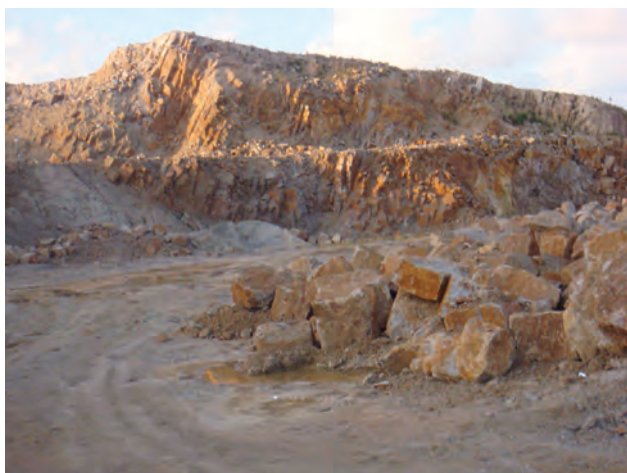
Foto 29 – Frente de lavra do tufo vulcânico (ignimbrito). Área em atividade do Grupo João Santos. Engenho Saco/Ipojuca.
