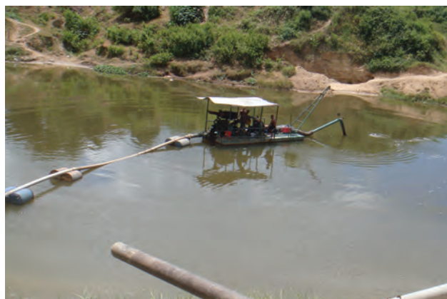
Foto 6 - Extração de areia lavada com draga flutuante no leito ativo do Rio Ipojuca. Depósito do Engenho Maranhão, Ipojuca.
