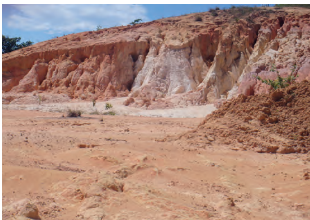
Foto 33 - Lavra de argila com evidências de erosão, na Rodovia Serrambi-PE 60, em Ipojuca.
