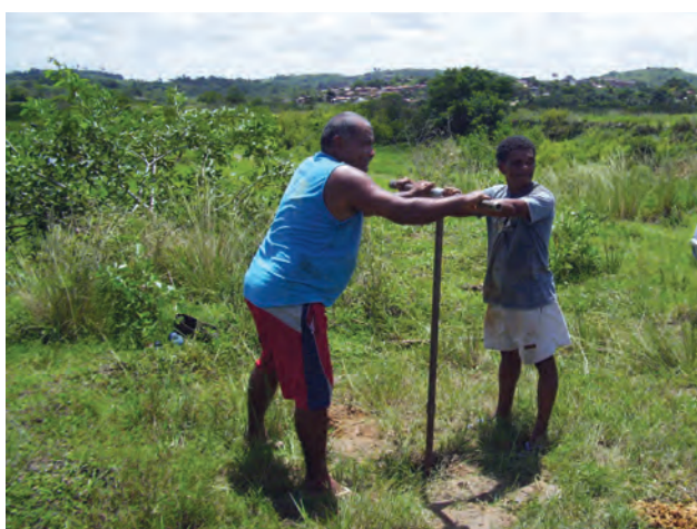
Foto 8 – Perfuração do furo 2 com o uso de trado manual no depósito aluvionar II de Lagoa do Recreio, Jaboatão dos Guararapes.
