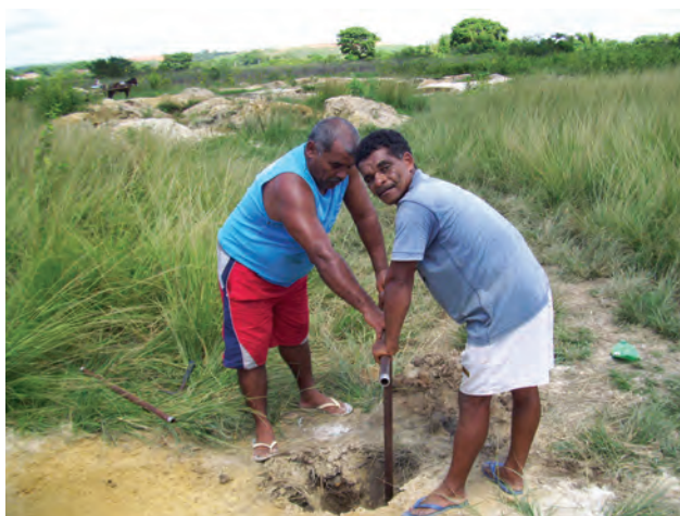
Foto 7 – Perfuração do furo 1 com o uso de trado manual no depósito aluvionar II de Muribeca, Jaboatão dos Guararapes.
