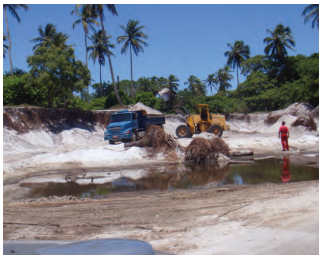
Foto 9 – Extração de areia de terraço marinho com pá carregadeira. Espessura do nível de areia é de 2,50m. Depósito de Feiteira, Ipojuca.
