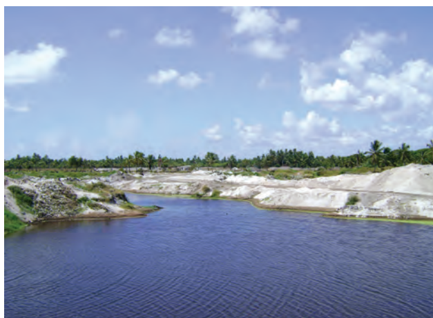
Foto 10 – Depósito de terraço marinho alagado (em parte) devido à exploração da areia. Ao fundo, a exploração prossegue. A espessura do nível de areia é de 2,0m. Notar, na base da escavação, a presença do arenito marrom. Depósito de Usina Salgado, Ipojuca.
