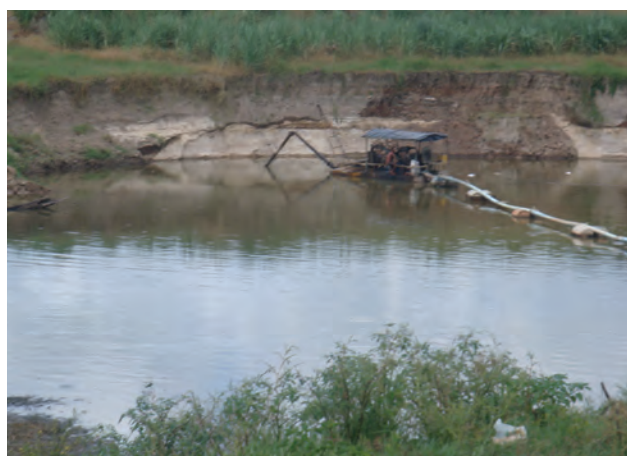
Foto 5 - Extração de areia lavada com draga flutuante no leito ativo do Rio Ipojuca. Depósito da Usina Ipojuca, Ipojuca.
