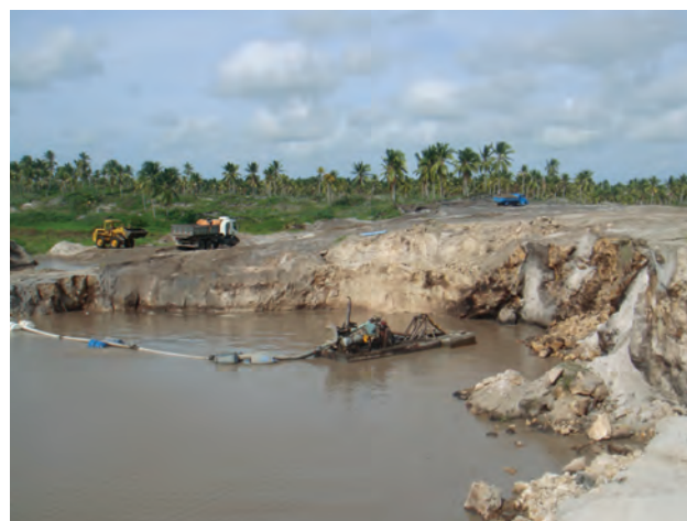
Foto 38- Lavra de areia, não convencional, em cava artificial, na Fazenda Mulata, em Itapissuma
