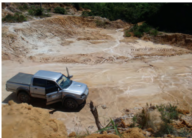
Foto 36 - Extração de argila sem nenhuma recuperação, provocando transporte de material para as partes baixas, provocando assoreamento, na zona rural de Cabo de Santo Agostinho.
