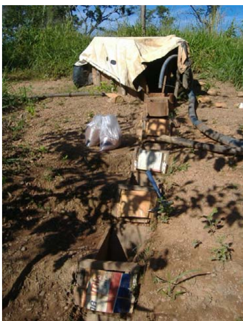
Figura 4.10 - Bica para recuperação de diamantes utilizada nos garimpos às margens do Rio Veríssimo, Catalão (GO).
