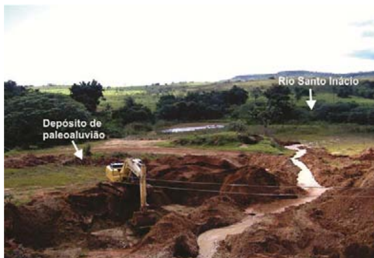
Figura 4.2 - Cata de garimpo de diamante de médio porte às margens do rio Santo Inácio, Distrito Diamantífero de Coromandel. Paleoaluvião é o principal tipo de depósito explorado nesta região.
