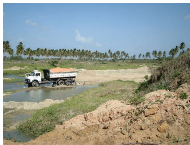
Figura 5.9 – Aspecto do local da retirada de areia no leito do rio Trairí no município de São José de Mipibu (RN). Afloramento MG293. Ponto de recurso mineral 186are, no mapa geológico. Garimpo ativo artesanal com coleta manual e transporte por caminhão caçamba.
