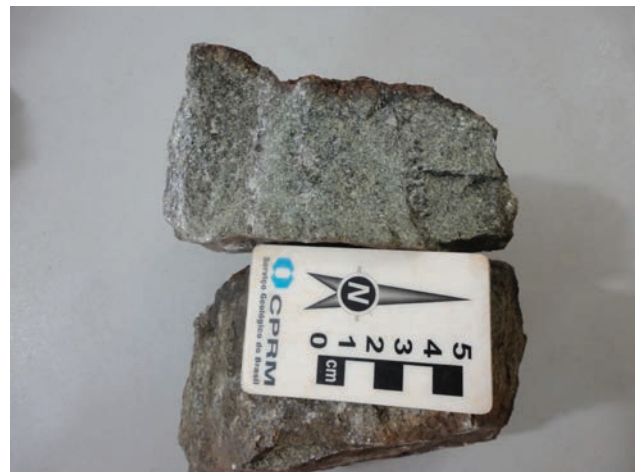
Figura 3.13 – Detalhe do diopsídio piroxenito do Complexo Riacho das Telhas. Afloramento MG-416, Fazenda Ulisses (Monte Alegre/RN).
