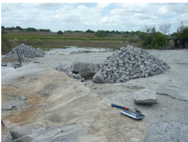
Figura 5.25 – Detalhe do paralelepípedo produzido em pedreira de Santo Antônio (RN). Afloramento MG353. Ponto de recurso mineral 194bt, no mapa geológico. Garimpo ativo.
