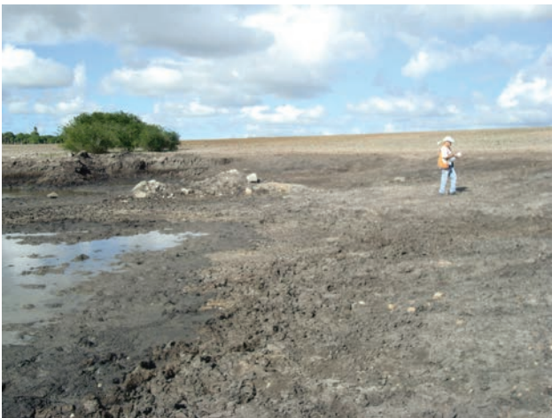
Figura 5.34 – Visão geral da extração de diatomita em Pajuçara, Monte Alegre (RN). Este material é utilizado por olarias próximas para a confecção de telhas e tijolos brancos. Afloramento MG401. Ponto de recurso mineral 101dt, no mapa geológico. Garimpo ativo.
