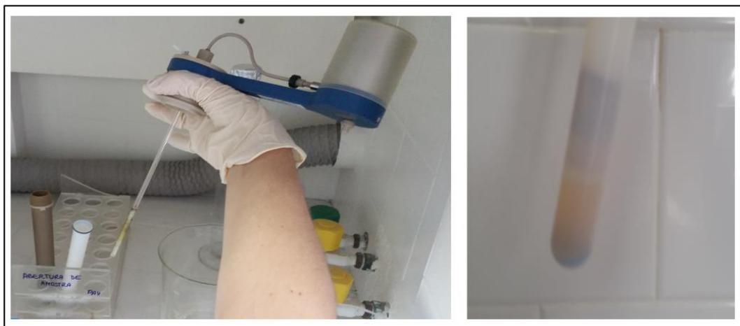
Figura 16 - Foto do sensor e do tubo após abertura com água régia
