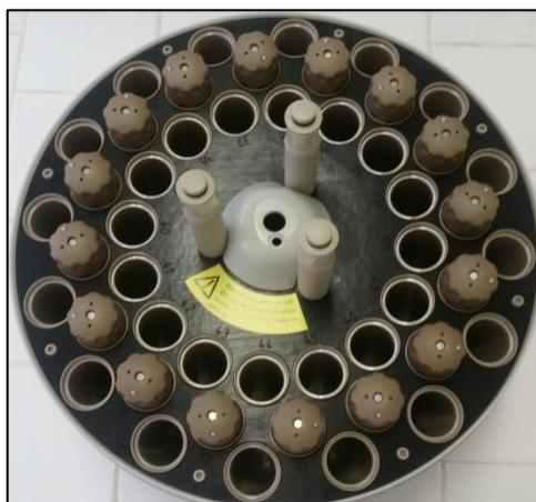
Figura 9 - Foto dos frascos distribuídos no rotor do micro-ondas
